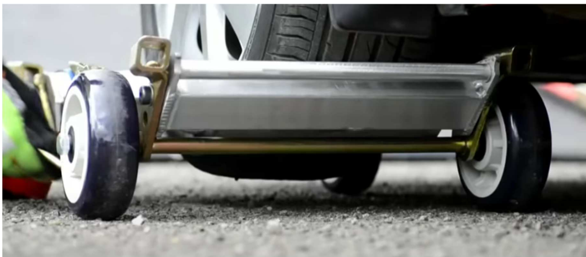
Obr. 6 Detail uchycení kol zvedáku RED Collins Carrier Dolly [2]
