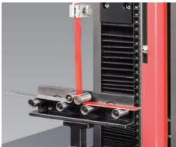
Obrázek 25. 90°zkouška odlupování na zařízení zwickiLine [16]
