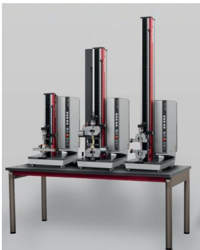
Obrázek 23. Modelová řada univerzálních zkušebních zařízení zwickLine (Z0.5, Z2.5, Z5.0) [16]
