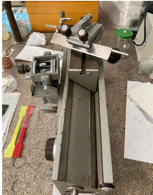
Obr. 25 Sáňový mikrotom pro přípravu mikroskopických preparátů
