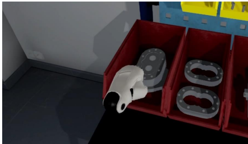
Obr. 80: Úkon uchopení dílu příruby čerpadla
