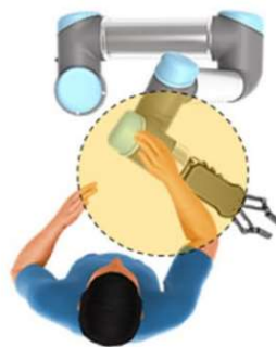
Obr. 24 - Schéma ručního navádění robota [24]
