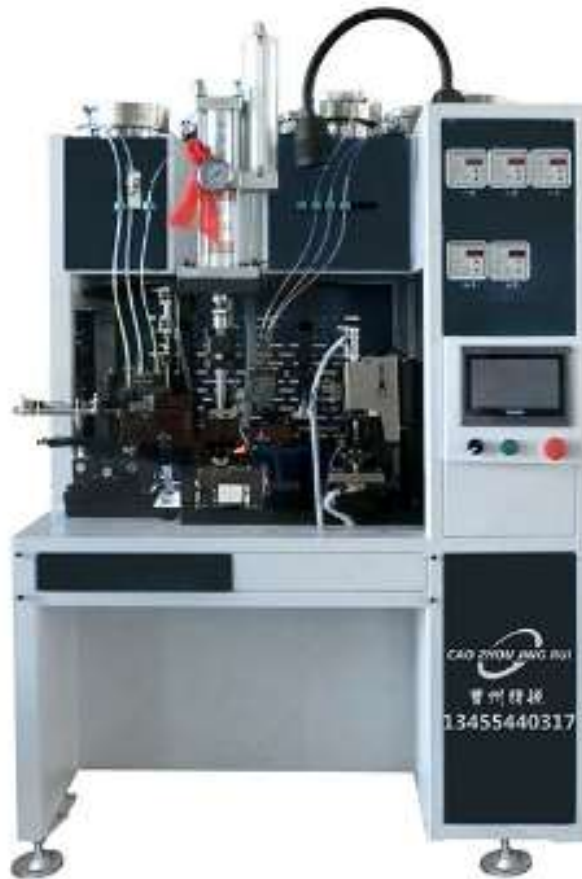
Obr. 37 - Lis na vyplňování cylindrických zámkových vložek [35]
