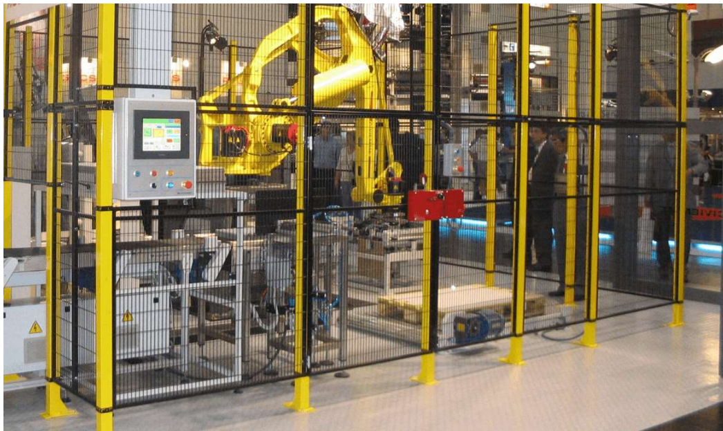
Obr. 22 - Zabezpečení dle normy EN ISO 10218-2 [23]
