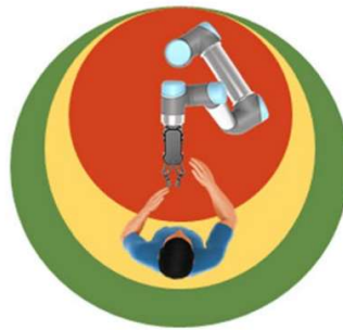
Obr. 25 - Schéma monitorování vzdálenosti a rychlosti [24]
