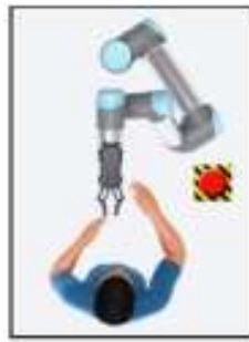
Obr. 23 - Schéma monitorovaného zastavení [24]
