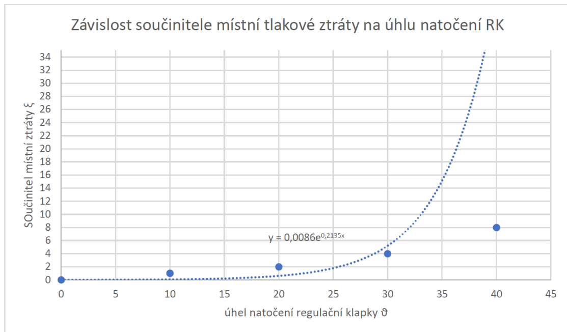
Obrázek 8 – Graf závislosti součinitele místní tlakové ztráty na úhlu natočení regulační klapky [6]
