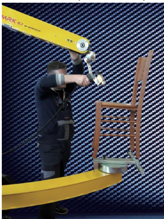
Obrázek 1: Programování lakovacího robotu Epistolio MRK. [2]
