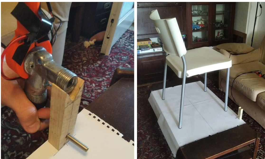
Obrázek 28: Prototyp kalibračního přípravku se stříkací pistolí a jeho umístění v rámci souřadnicového systému stolu.
