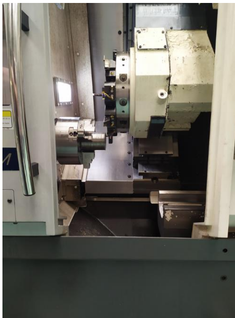
Obrázek 15: Nastavení nulového bodu osy Z
