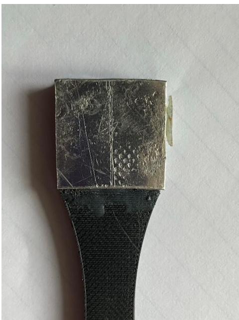
Obrázek 16 Nalepený hliníkový plíšek na vzorek materiálu Diran pro tahovou zkoušku
