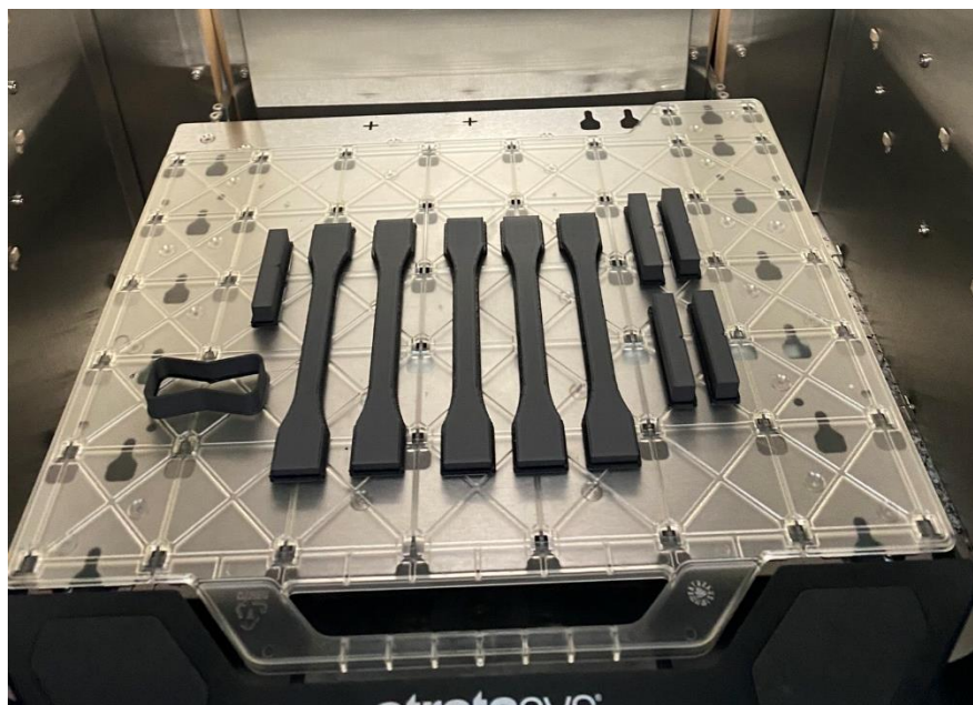
Obrázek 14 Výsledek tisku materiálu Diran 410MF07 na tiskárně F370
