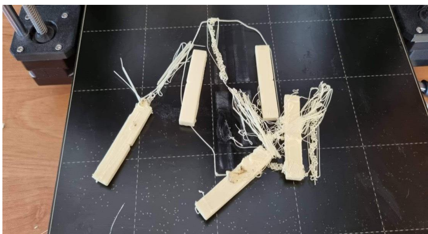
Obrázek 12 Chybný průběh tisku vzorků pro zkoušku rázové houževnatosti z nylonu
