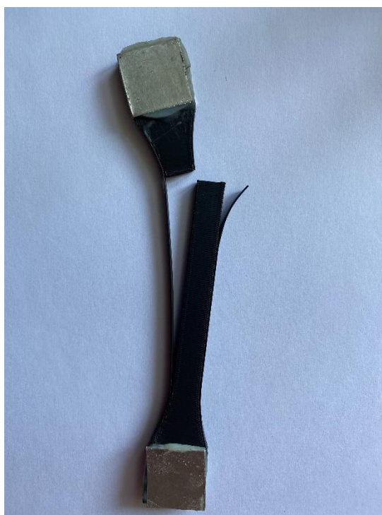
Obrázek 17 Vzorek materiálu Diran po přetržení
