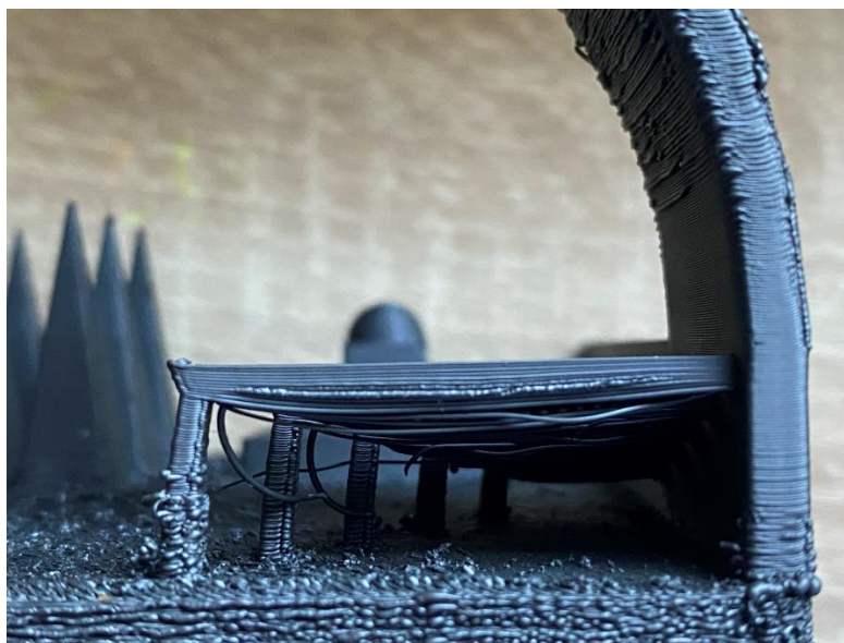
Obrázek 34 Vybraný test přemostění materiálu Diran
