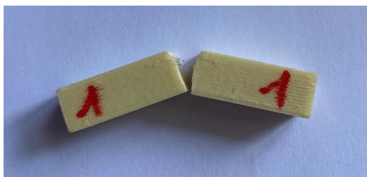
Obrázek 21 Přelomený vzorek materiálu nylon
