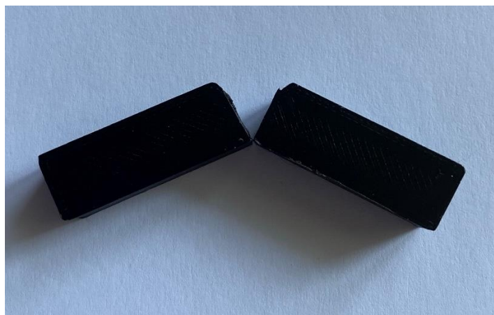
Obrázek 23 Přelomený vzorek materiálu PET-G
