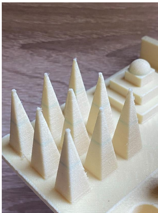
Obrázek 32 Vybraný test stringování materiálu nylon
