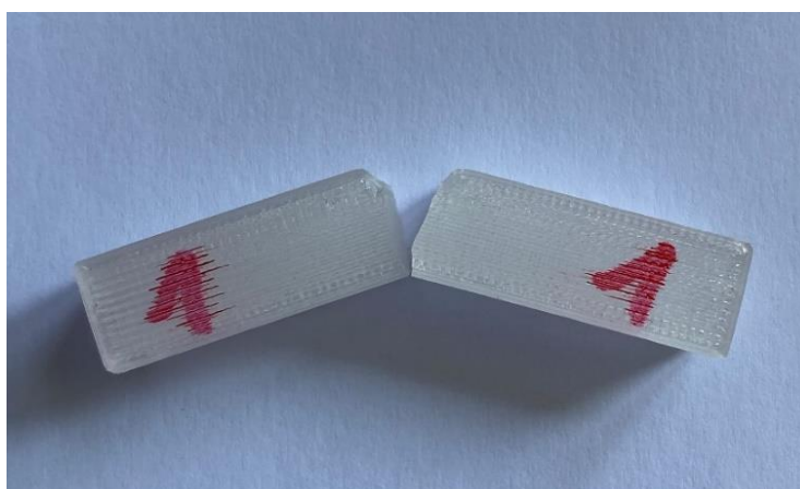
Obrázek 24 Přelomený vzorek materiálu PMMA
