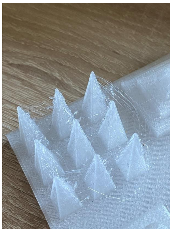
Obrázek 33 Vybraný test stringování materiálu PMMA
