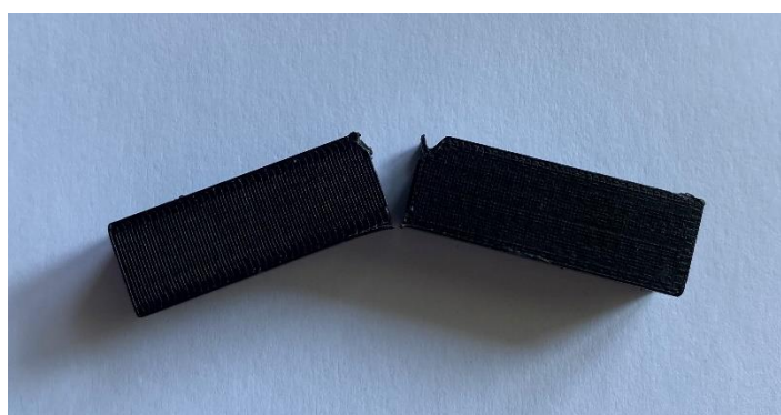
Obrázek 22 Přelomený vzorek materiálu PC-ABS
