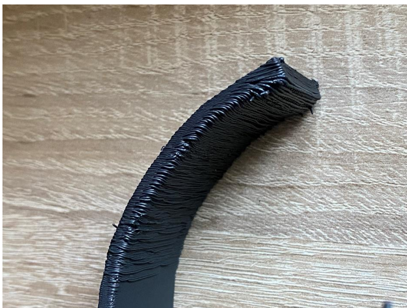
Obrázek 31 Vybraný test převisu materiálu Diran
