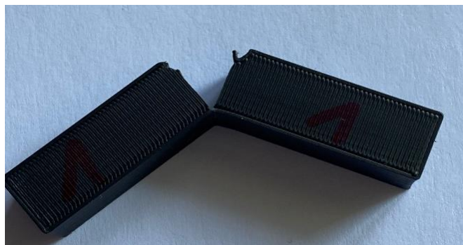
Obrázek 20 Částečně přelomený vzorek materiálu Diran
