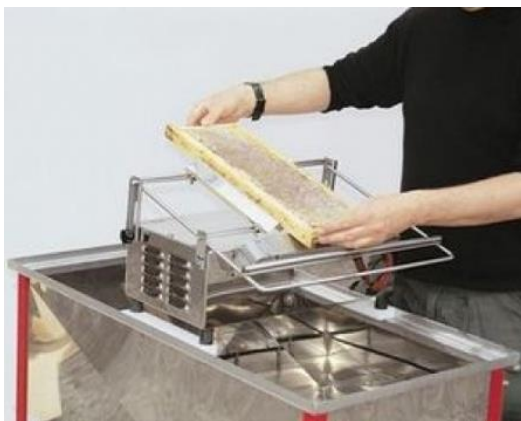
Obrázek 49 - Odvíčkovací zařízení s horizontálním kmitajícím nožem. [74]
