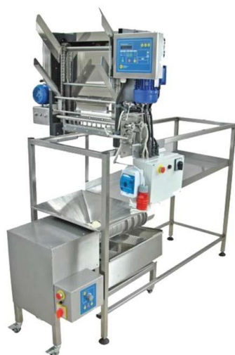
Obrázek 23 - Automatizovaný odvíčkač se šnekovým lisem, odvíčkač s pneumatickým odebráčem. [74][76]
