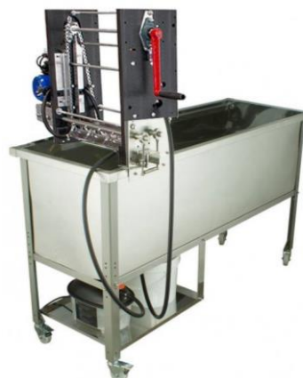
Obrázek 22 - Odvíčkač s válcovými noži a odvíčkač s řetězovým podavačem. [74][76]
