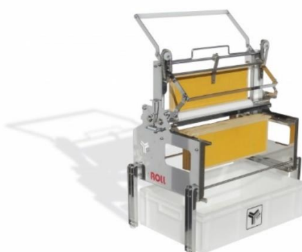
Obrázek 22 - Odvíčkač s válcovými noži a odvíčkač s řetězovým podavačem. [74][76]
