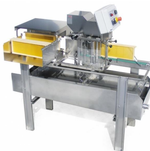
Obrázek 23 - Automatizovaný odvíčkač se šnekovým lisem, odvíčkač s pneumatickým odebráčem. [74][76]
