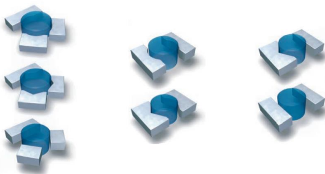
Obrázok 4.1: Kombinácie úchopu predmetu jednotnej geometrie [8]
