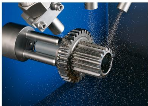
Obrázek 17 Princip metody kuličkování [35][36]
