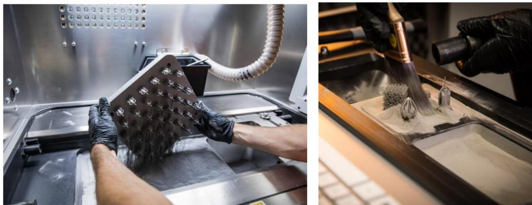
Obrázek 38 Pracovní prostor technologie DMLS [56]
