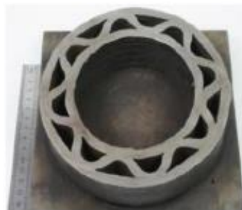
Obrázek 40 Proces technologie WAAM (vlevo), výsledná součást (vpravo) [56]
