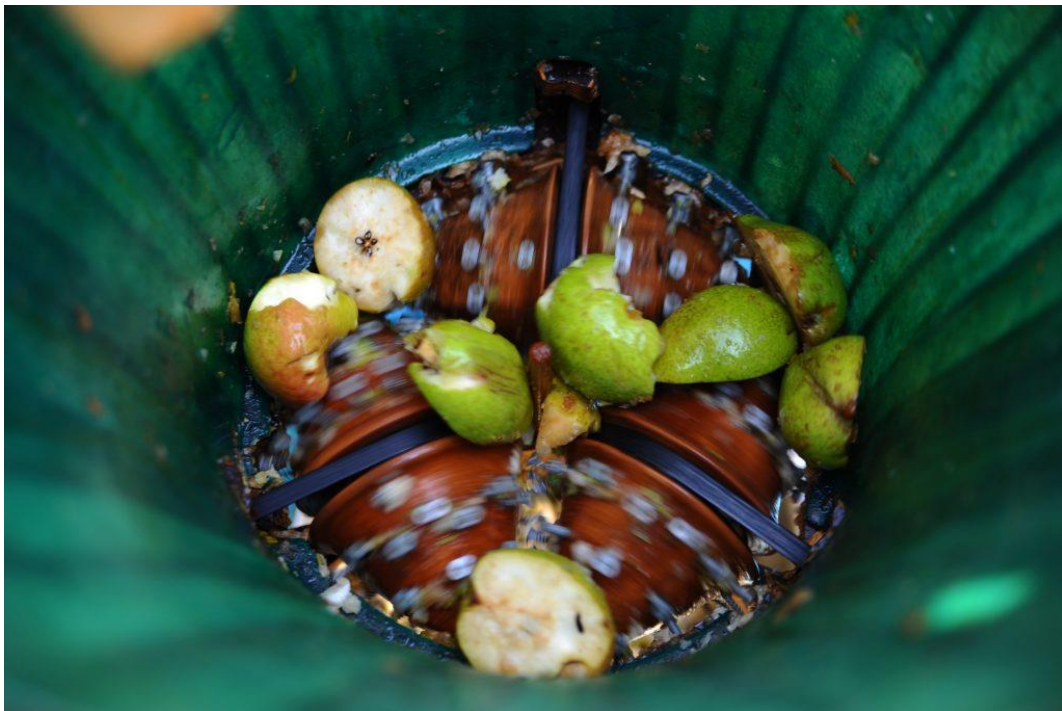
Obrázek 10.: Drtící mechanismus šlapostroje[11]
