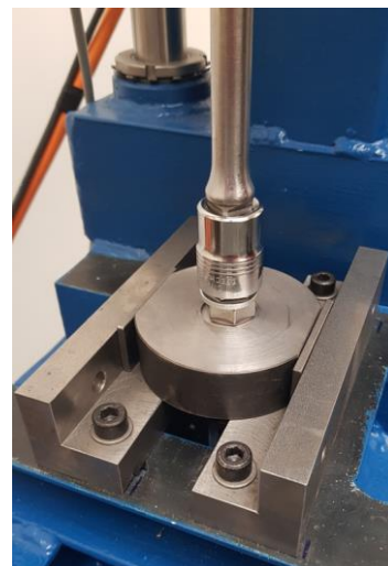
Obr. 49.: Nástrčná hlavice s prodlužovacím nástavcem na testované matici [autor]
