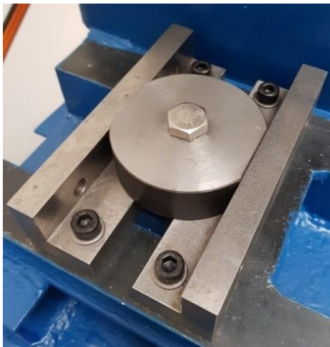
Obr. 46.: Uložení testovaného šroubu [autor]
