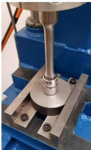
Obr. 48.: Nástrčná hlavice s prodlužovacím nástavcem na testovaném šroubu [autor]
