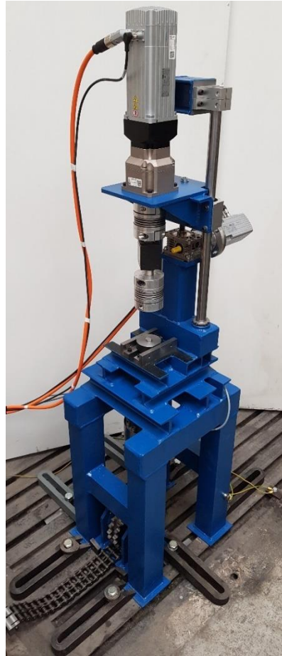
Obr. 29.: Reální podoba experimentálního zařízení pro komplexní testování šroubových spojů [autor]
