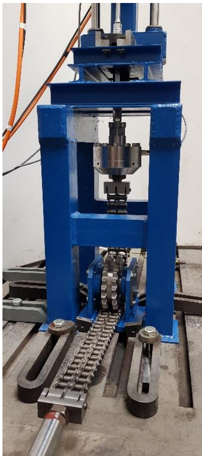
Obr. 50.: Připojení testovaného šroubu k taženému řetězu [autor]
