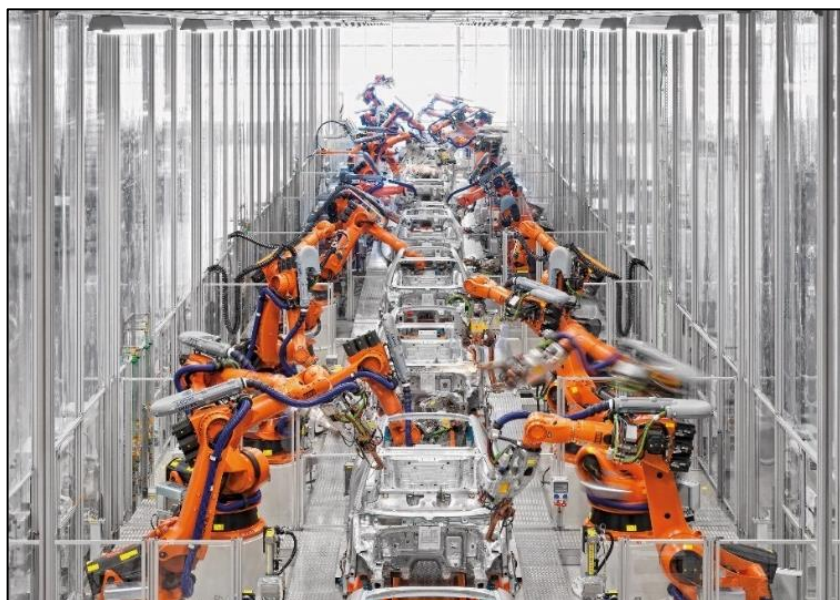
Obr. 3 Robotická linka pro bodové svařování karoserií automobilů [2]
