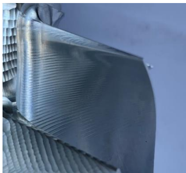
Obr. 94 – Lopatka 4 kolo D160 konvenční způsob obrobení
