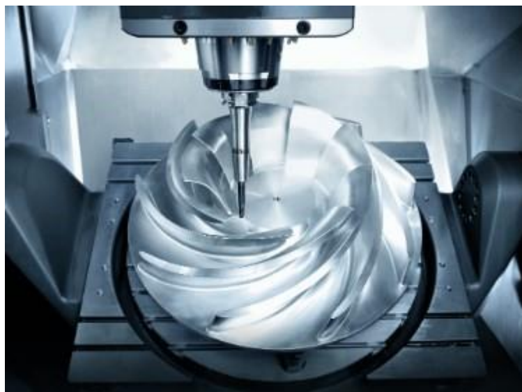
Obr. 4 - Znárodnění 5D obrábění na oběžném kole [4]
