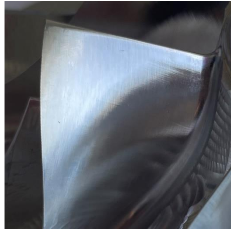
Obr. 93 - Lopatka 3 kolo D100 obrobeno s využitím optimalizační funkce
