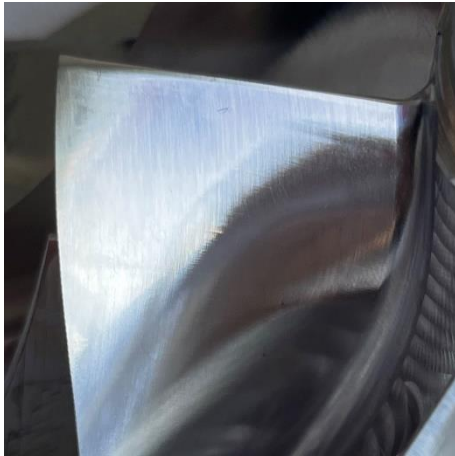
Obr. 92 - Lopatka 1 kolo D100 konvenční způsob obrobení
