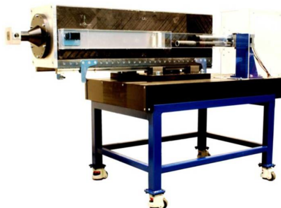
Obrázek 9: Přídavný odměřovací systém deformace volného konce smykadla [51]
