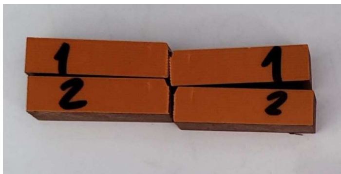
Obr. 31 – Porušené vzorky po zkoušce rázové houževnatosti
