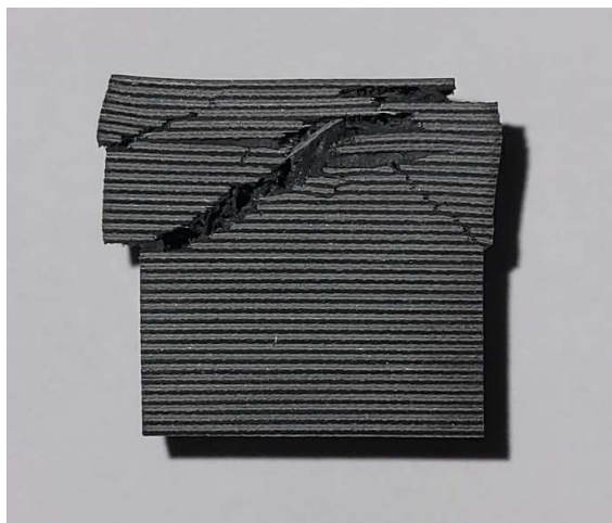
Obr. 21 – Porušení vzorku z 1.skupiny po zkoušce tlakem
