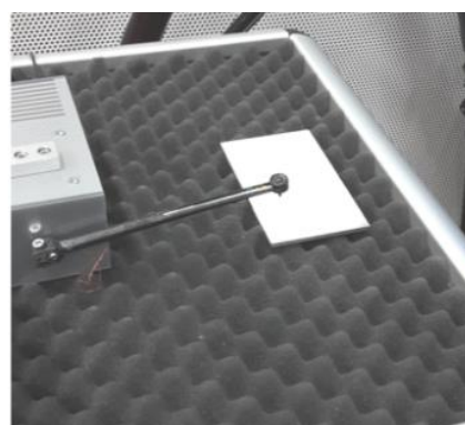
Obrázek 3.4: Uložení na vlnitém molitanu [16]
