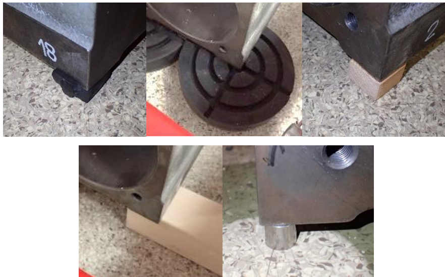
Obrázek 4.17: Uložení – z levého horního rohu: pryžové podložky, gumové disky, dřevěné podložky, dřevěné špalíky, ocelové trubičky
