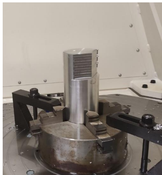
Obr. 6.21 Obrobení Zkosených ploch (pomocí cyklu 800)
