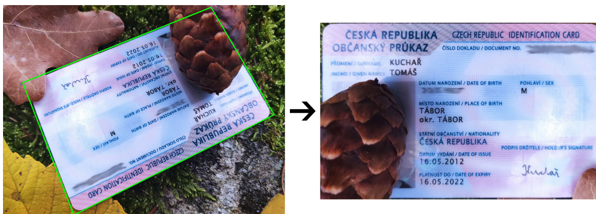
Obrázek 4.3: Ukázka použití perspektivní transformace pro srovnání nalezeného dokladu.
