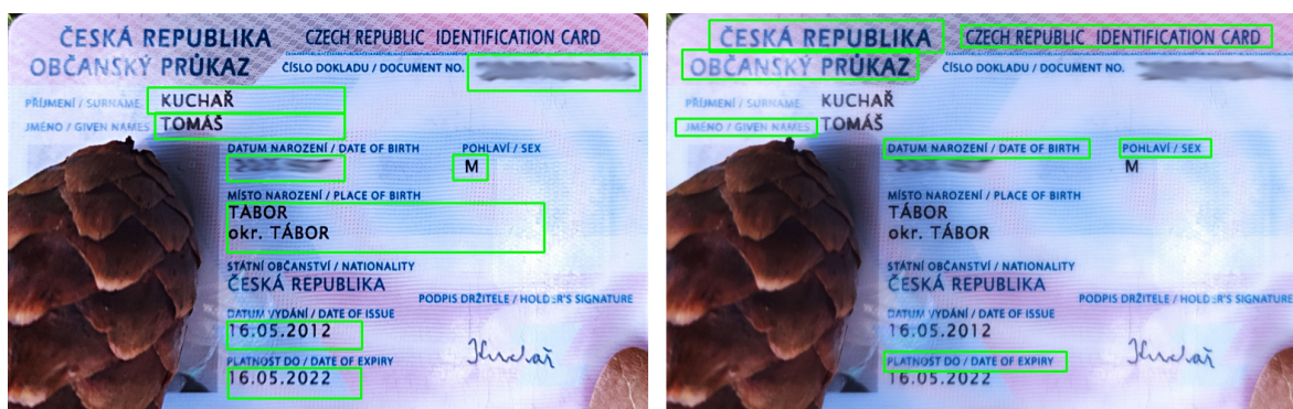
Obrázek 4.4: Vyznačení hranic čtených oblastí ve zpracované fotografii občanského průkazu. Vlevo jsou vyznačeny oblasti obsahující požadovaná data, vpravo jsou vyznačeny kontrolní oblasti.
