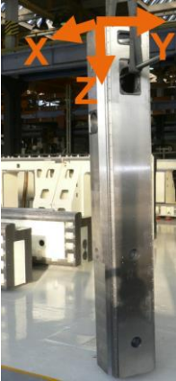
Obr. 8: Prototyp hybridního smykadla při EMA tělesa.
