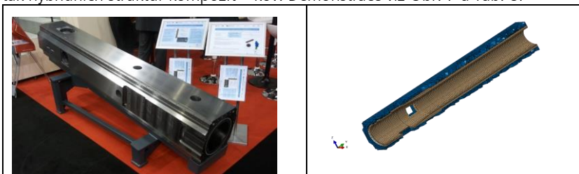
Obr. 7: Prototyp hybridního smykadla a jeho výpočtový model
