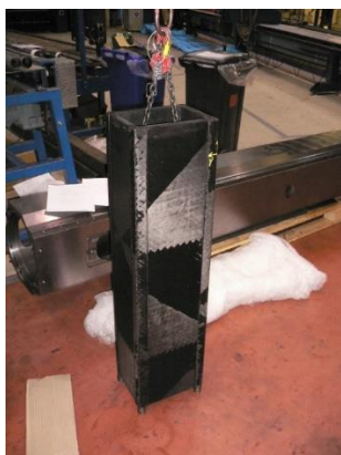
Obr. 87: Zavěšení deskového smykadla při modální analýze – pouze kompozitní tělo smykadla
