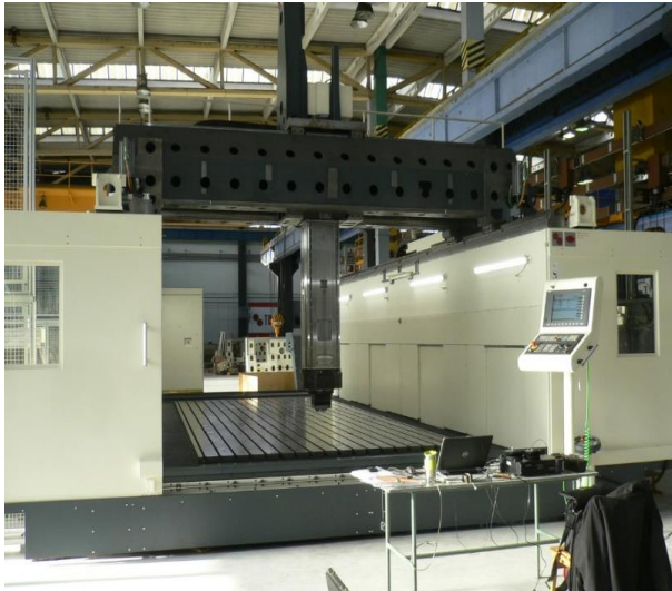
Obr. 17: Nosná struktura obráběcího stroje s detailem na smykadlo (stroj MCV společnosti TAJMAC – ZPS).
