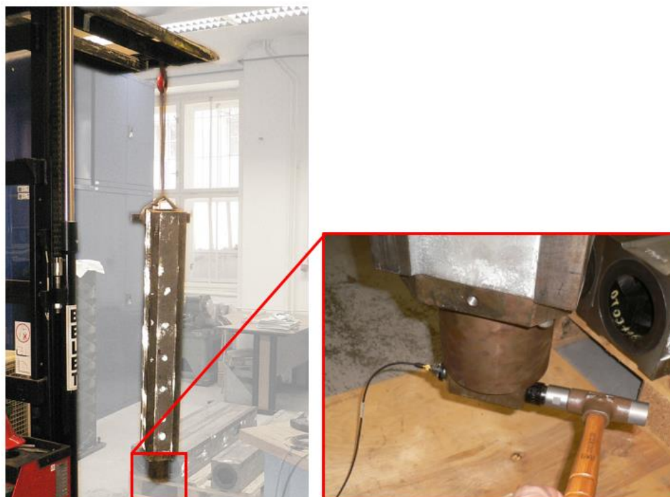
Obr. 129: Konfigurace pro měření EMA modelových hybridních smykadel s vyznačením buzení. [A2]
