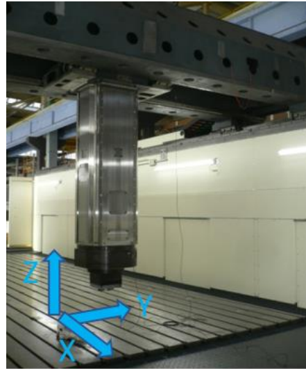
Obr. 17: Nosná struktura obráběcího stroje s detailem na smykadlo (stroj MCV společnosti TAJMAC – ZPS).
