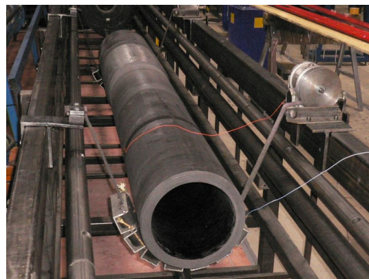
Obr. 116: Kompozitní výztuž smykadla při měření EMA.
