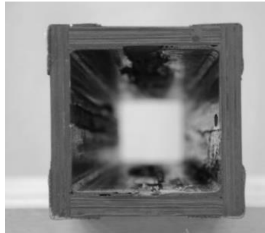
Obr. 20: Kompozit 2: Kompozitní profil z lepených desek s vyztužením rohů.
