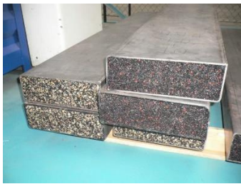
Obr. 142: Ocelové profily vyplňované částicovým kompozitem. [A2]
