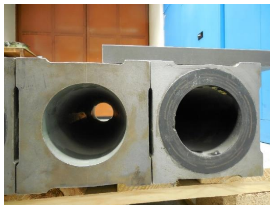
Obr. 102: Porovnání struktury referenčního kovového smykadla s hybridním smykadlem. [A2]
