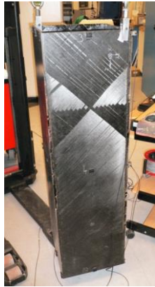
Obr. 62: Okrajové podmínky kompozitního-korkového tubusu smykadla při EMA.
