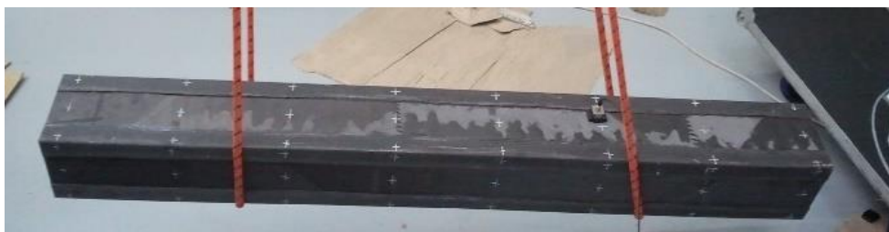
Obr. 30: Uložení modelového vzorku přes dva popruhy v uzlových bodech prvního ohybového tvaru.
