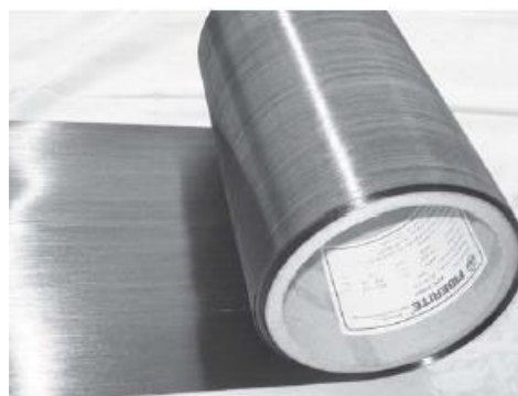
Obr. 9: Polotovar - jednosměrový kompozit pro navíjení/kladení – vrstva vláken s matricí. Převzato z [44].
