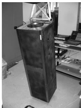
Obr. 123: Ocelový svařenec smykadla 2. [A3]
