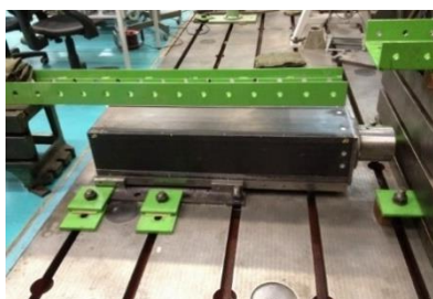
Obr. 91: Druhý vlastní tvar z EMA – ohyb v horizontálním směru, f 249 Hz.
