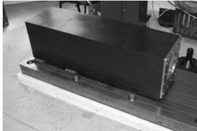
Obr. 63: Okrajové podmínky hybridního smykadla při EMA s uložením. [A3]
