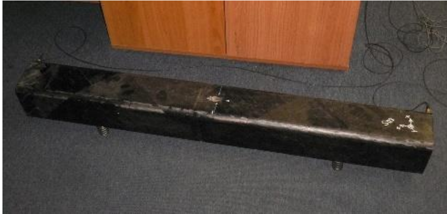
Obr. 28: Uložení vzorku Kompozit 1 přes pružiny v poloze uzlových bodů prvního ohybového tvaru.
