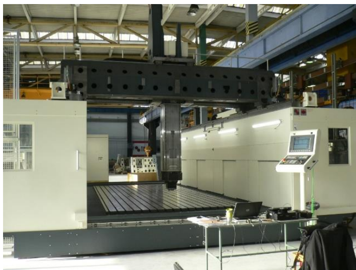
Obr. 140: Konfigurace stroje řady MCV při experimentální modální analýze. [A20]
