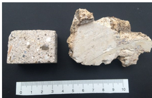
Obrázek 5 Hrudky pojiva různé velikosti v maltách z Karlova mostu (foto D. Frankeová)
