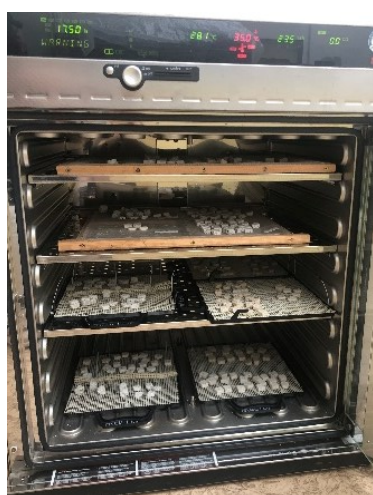
Obr. XX: Vlevo – vzorky umístěné v CO 2 inkubátoru, vpravo - záznam relativní vlhkosti a teploty prostředí uložení vzorku sad 1 a 2 (CO 2 inkubátor) z dataloggeru Comet S3120 (červeně relativní vlhkost % RH, modře teplota °C, zeleně rosný bod °C).
