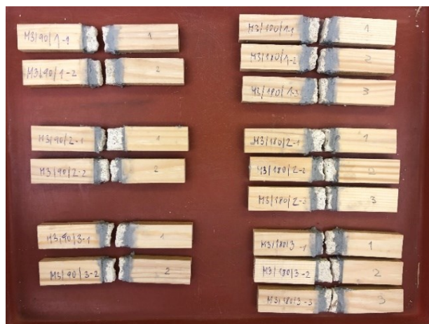
Obr. XX: Vzorky malty M3 po zkoušce v tahu za ohybu.
