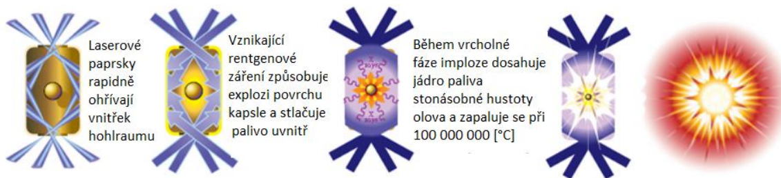
Obrázek 11 – Fáze fúze s inerciálním udržením při nepřímém ohřevu za pomoci hohlraumu – zdroj [9]
