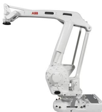
Obrázek 3-2: Paletizační robot IRB 660 od společnosti ABB [4]
