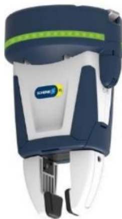
Obrázek 4-10: Úchopná hlavice EGP od firmy Schunk [22]
