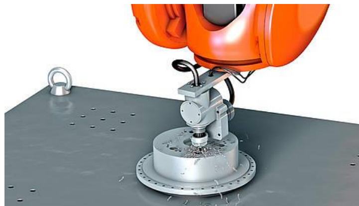
Obrázek 4-2: Příklad obrábění robotickou hlavicí, zde konkrétně frézování [11]
