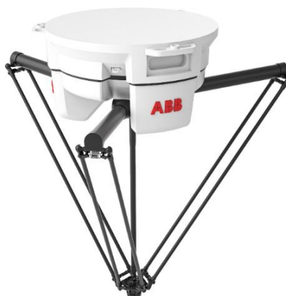
Obrázek 3-4: Delta robot od společnosti ABB [6]
