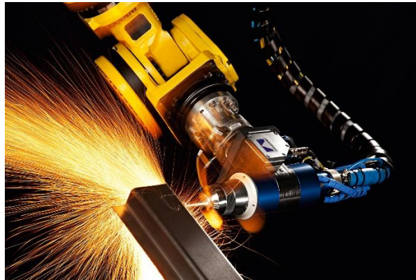
Obrázek 4-1: Robotický koncový efektor pro laserové řezání. [9]
