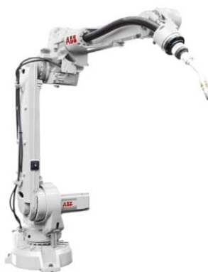
Obrázek 4-4: Svařovací hlavice na průmyslovém robotu [15]
