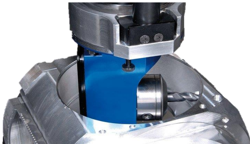
Obr. 1: Frézování drážky pravoúhlou frézovací hlavou [1]
