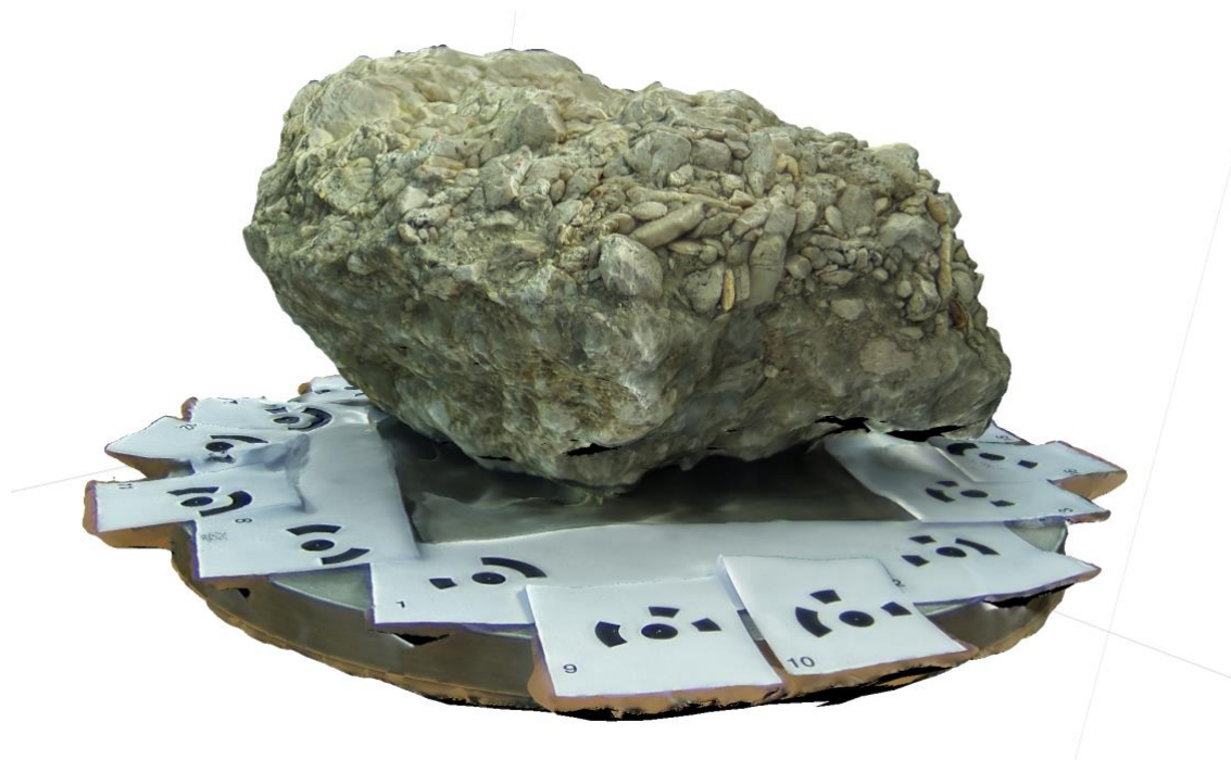
Obr. 27 – Výsledný 3D model z kamery Raspberry
