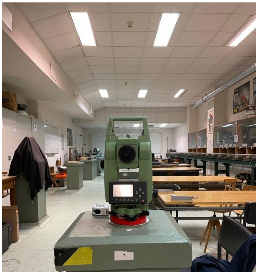
Obr. 33 – Totální stanice Leica TCR307
