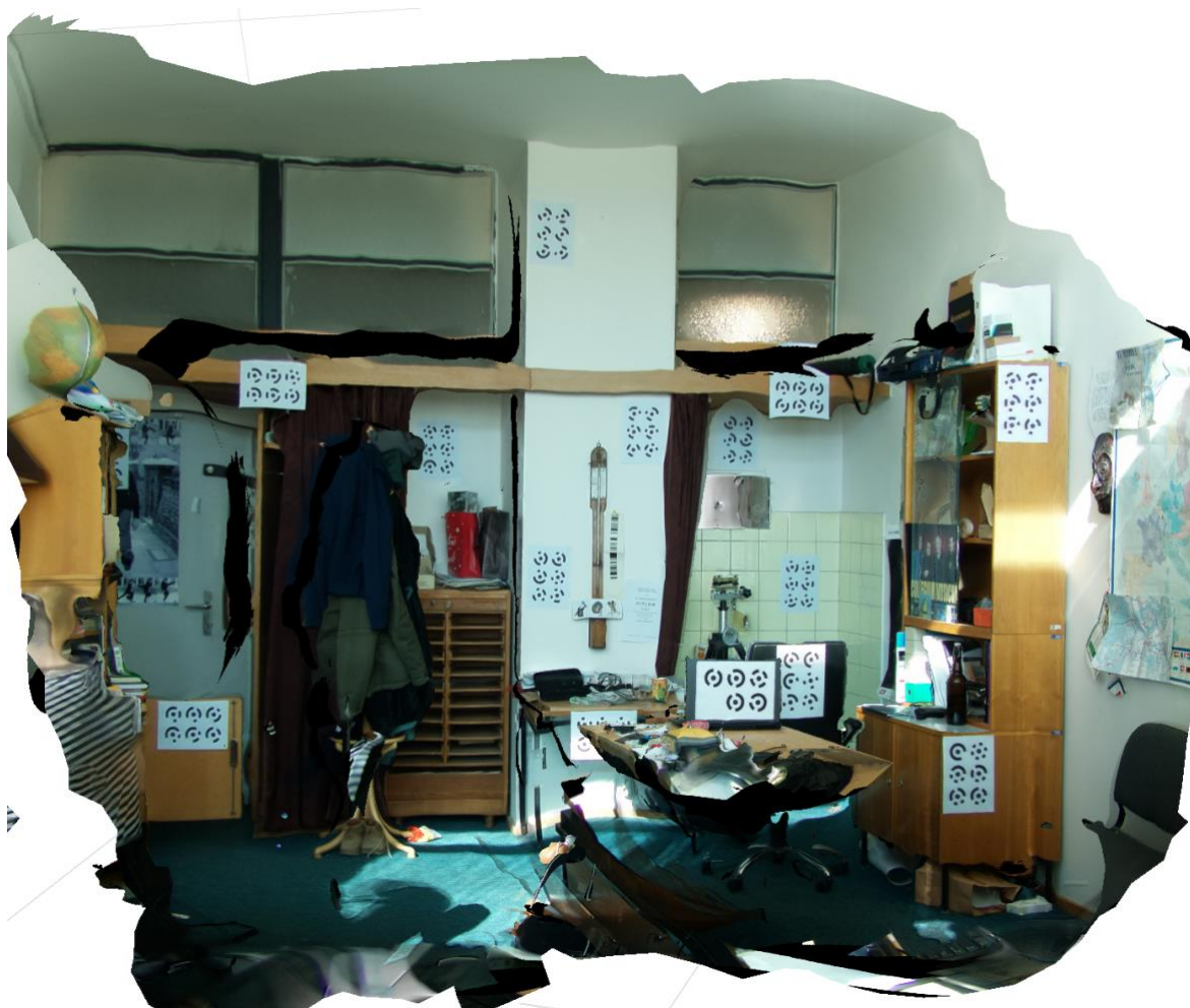
Obr. 19 – Experimentální 3D model z kalibrace kamery
