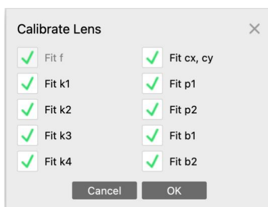
Obr. 18 – Výstupní parametry z kalibrace kamery
