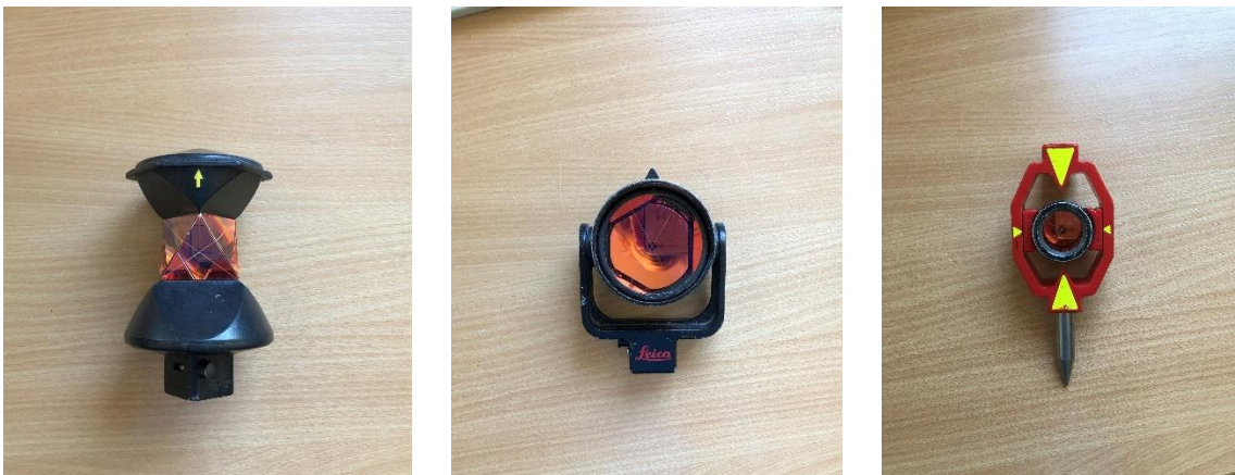
Obrázek 23 – Leica GRZ4 360° hranol, Leica GPR1 kulatý hranol, Leica GMP111 mini-hranol
