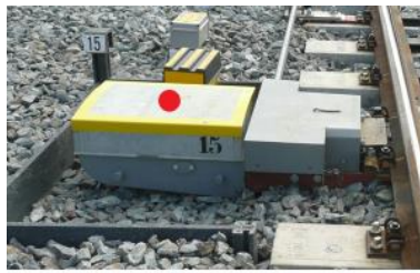
Obrázek 10 - konec kolejového obvodu, přestavník + záporník a pražce [1]
