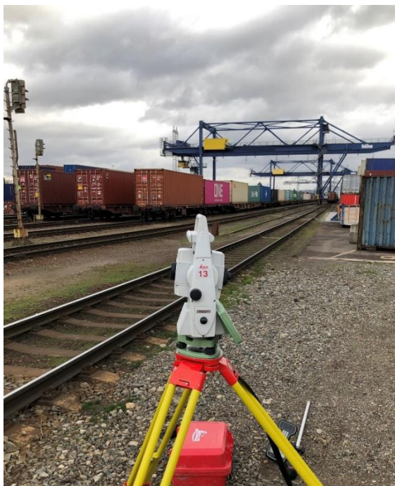
Obrázek 7 – Totální stanice Leica TS16, zaměřování výškopisu a polohopisu
