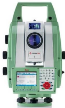
Obrázek 21 – Totální stanice Leica MS50 1 R2000 [17]
