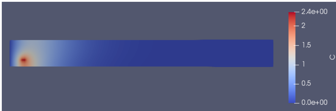
Obrázok 4.21 Simulácia rozptylu pasívnej prímеси nad plochým terénom
