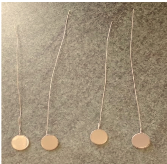
Obr. 21 Upevnění vzorků titanovým drátem
