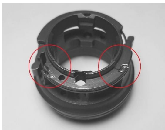
obr. 39 – díl s drážkami pro řetězové kolo (8) nalomený po uvolnění jeho praporků
