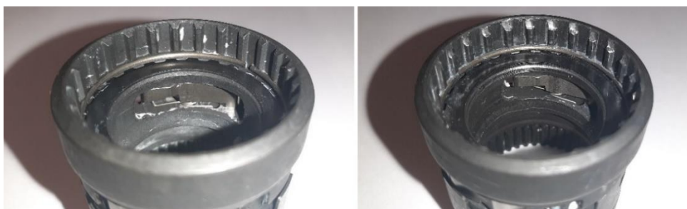
obr. 42 – detail dílu s korunovým kolem (5) nového (vlevo) a se zničeným vnitřním drážkováním (vpravo)
