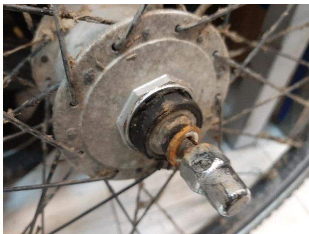
obr. 35 – zkorodovaná převodovka kola, které bylo několik dní pod hladinou Vltavy
