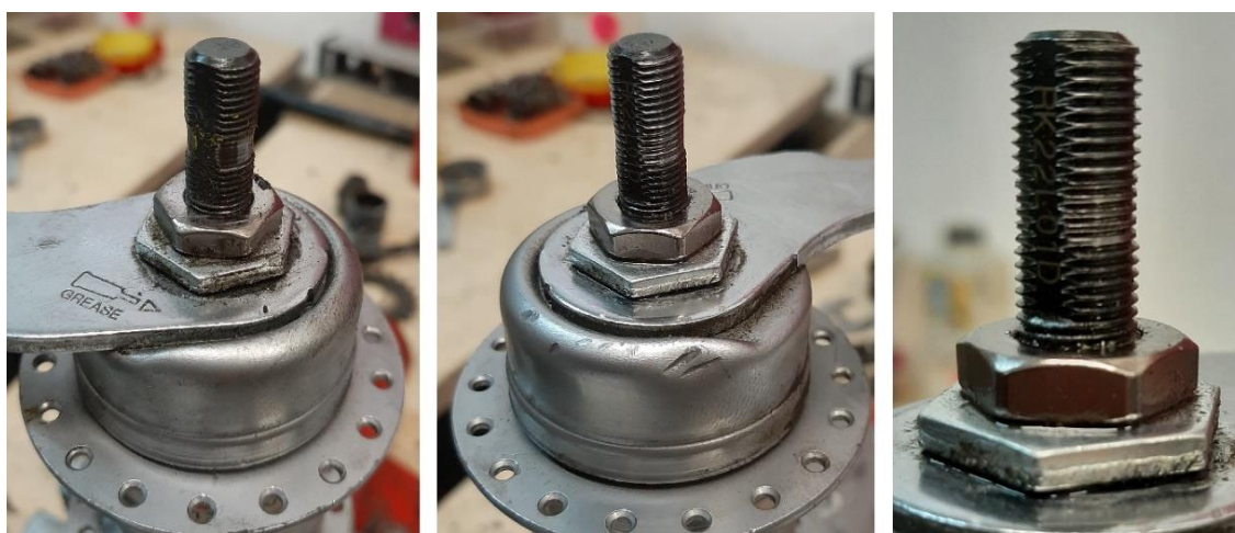
obr. 48 – závit osy (7a) před (vlevo) a po opravě (uprostřed a vpravo)
