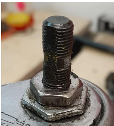
obr. 47 – zničená část závitu osy (7a) v důsledku protočení
