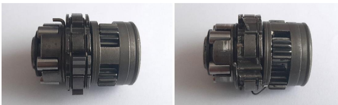
obr. 40 – díl s unašečem (4) nový (vlevo) a poškozený v důsledku ulomení jeho praporků (vpravo)
