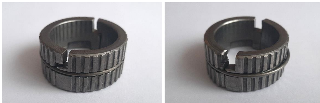
obr. 41 – brzdové čelisti (2) nové (vlevo) a poškozené v důsledku ulomení praporků dílu s unašečem (4) (vpravo)
