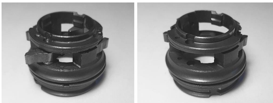
obr. 37 – díl s drážkami pro řetězové kolo (8) nový (vlevo) a bez obou praporků (vpravo)
