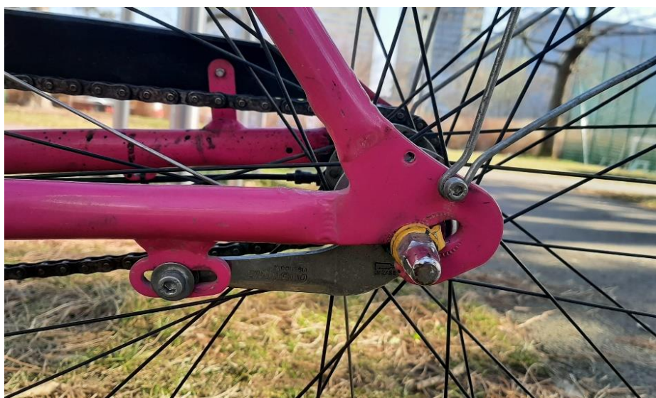
obr. 45 – uchycení držáku (16) do rámu pomocí šroubového spoje (17-19) (vlevo) a pojistné podložky (13) (vpravo)
