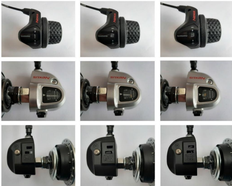
obr. 10 – polohy řadicí páčky z horního pohledu (2. řada fotografií) a spodního pohledu (3. řada fotografií) pro různé převodové stupně měněné na řadicí rukojeti (1. řada fotografií)
