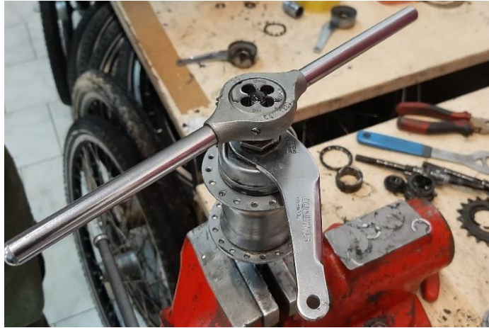
obr. 49 – oprava závitu osy (7a) závitníkem M9,5
