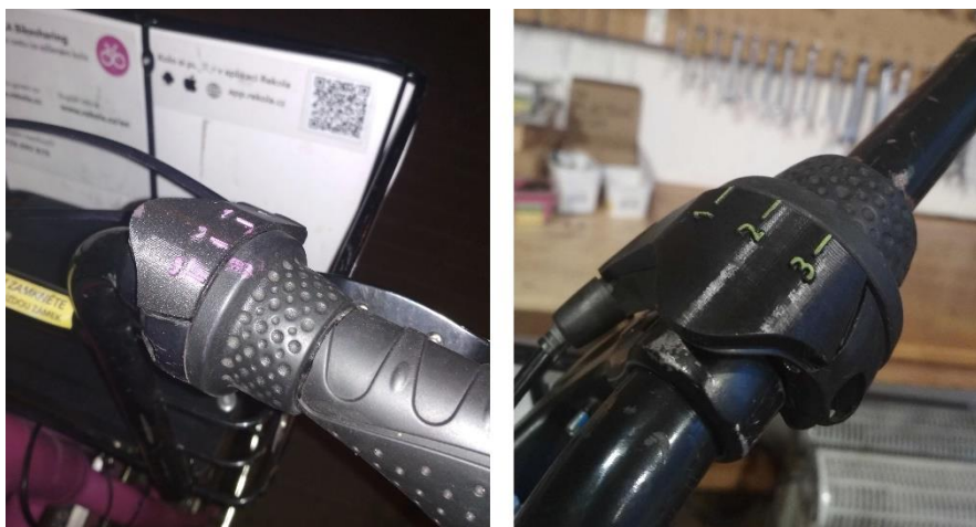
obr. 32 – náhradní plastové krytky vyrobené na 3D tiskárně společnosti Rekola
