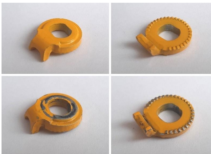
obr. 46 – pojistná podložka (13) nová (nahore) a poškozená v důsledku uvolnění a protočení držáku (16) (dole)
