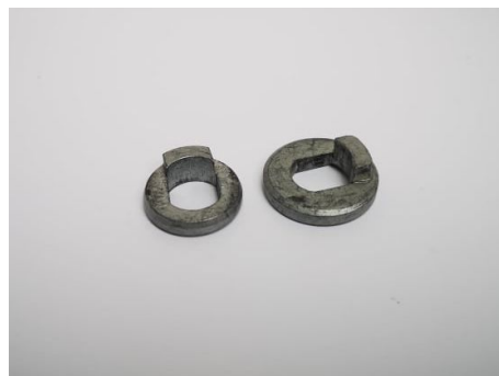
Obrázek 4.13: Podložka s nekruhovým otvorem
