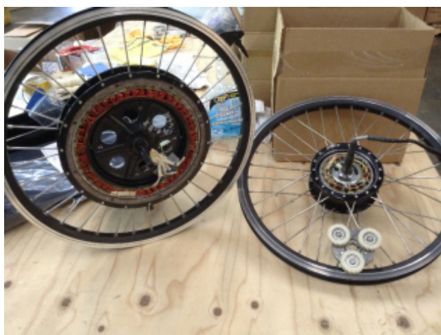
Obrázek 2.3: Porovnání přímého a zpřevodovaného motoru [19]
