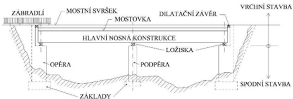
Obr.2.3: Základní části mostu [11]
