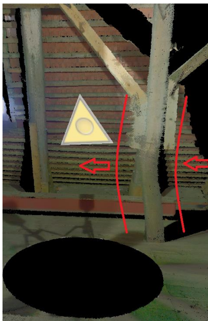
Obr. 44 – Příklad deformace způsobené chybou přístroje, LCR360
