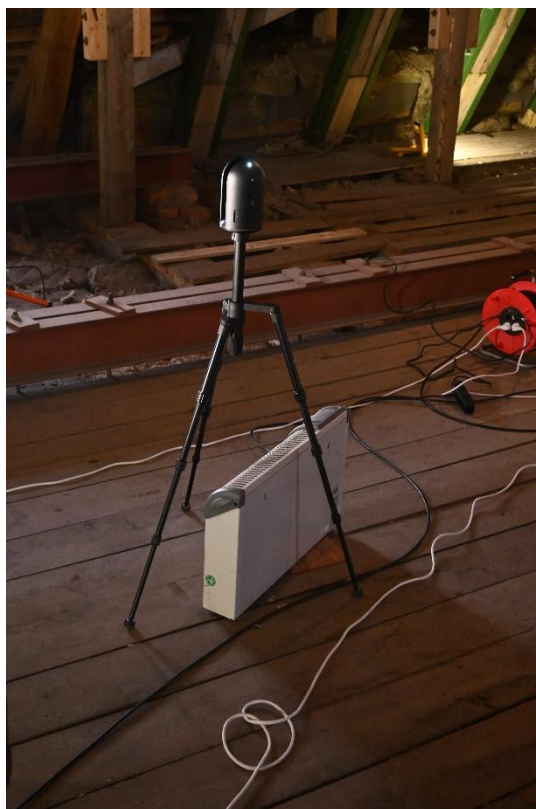
Obr. 12 – Skener zahříváný elektrickým topením
