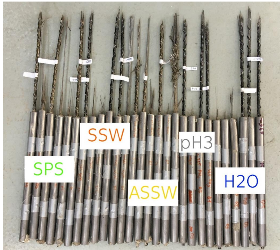
Obrázek 106: Druhy porušení BFRP po 360 dnech expozice
