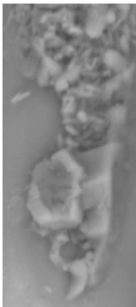
Obrázek 72: Detail vlákna s jiným korozním produktem
