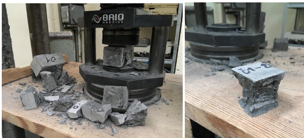
Obrázek 56 a 57: Lis se vzorkem a Rozdrcený vzorek po zkoušce
