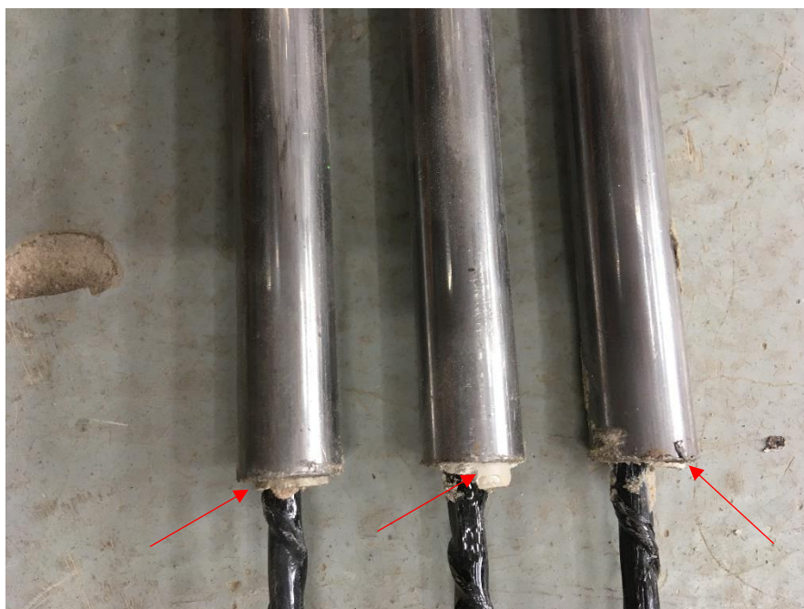
Obrázek 104: Viditelné proklouznutí kotevního materiálu v neděrované trubce
