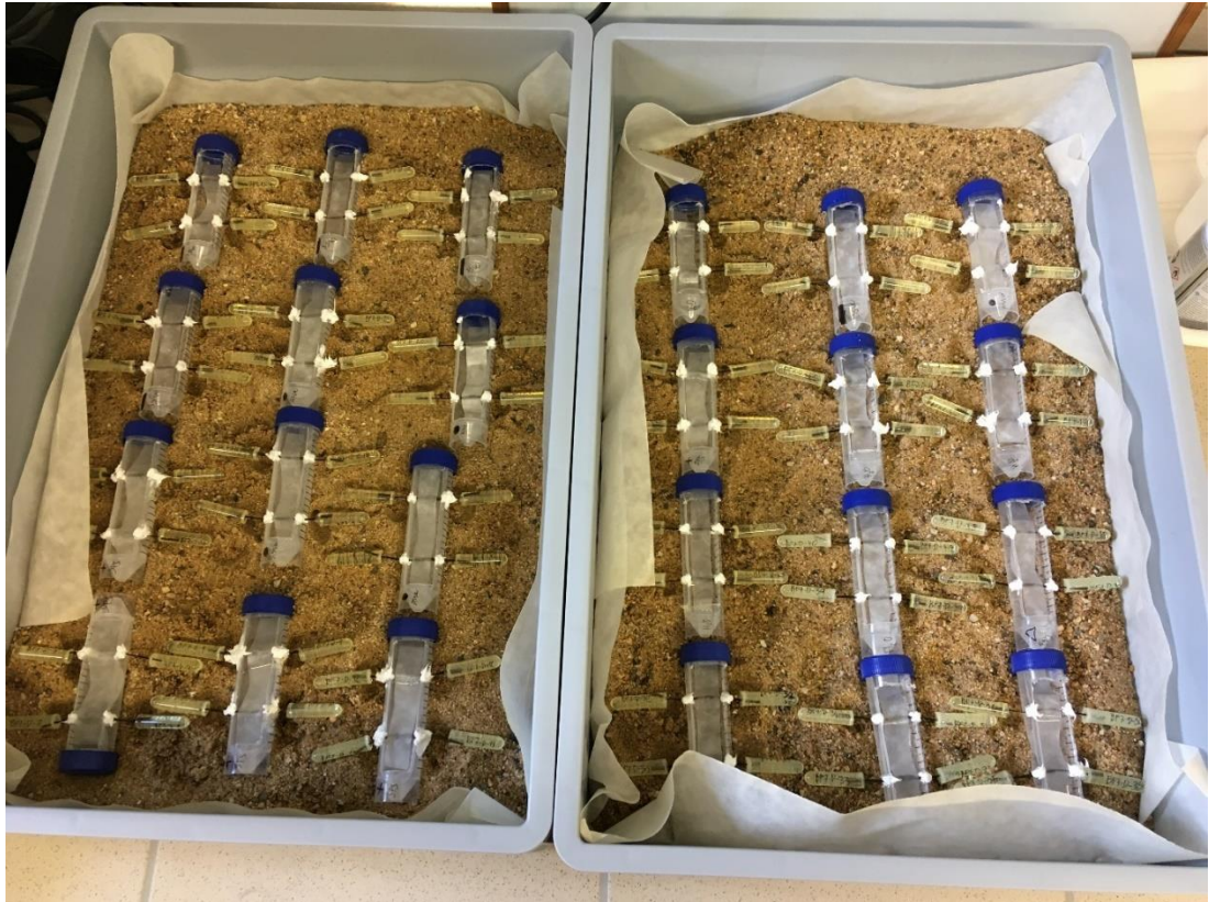
Obrázek 45: Plastové bedýnky s podstavci se zkušebními vzorky
