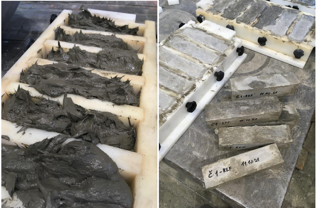
Obrázek 52 a 53: Směs ve formách před zhutněním a Trámečky po odbednění
