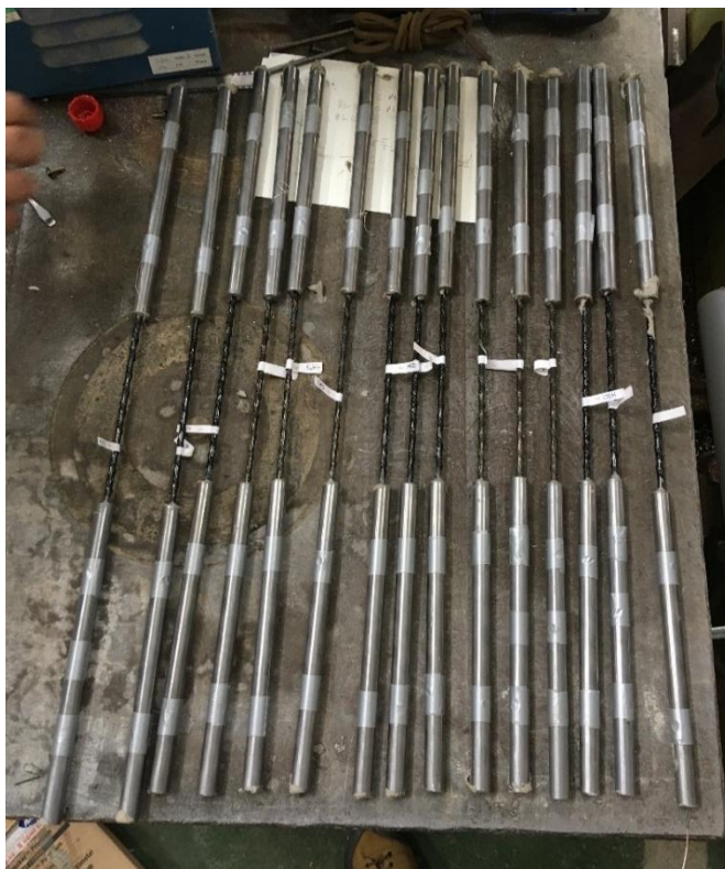
Obrázek 47: BFRP tyče s vytvořenou kotevní délkou
