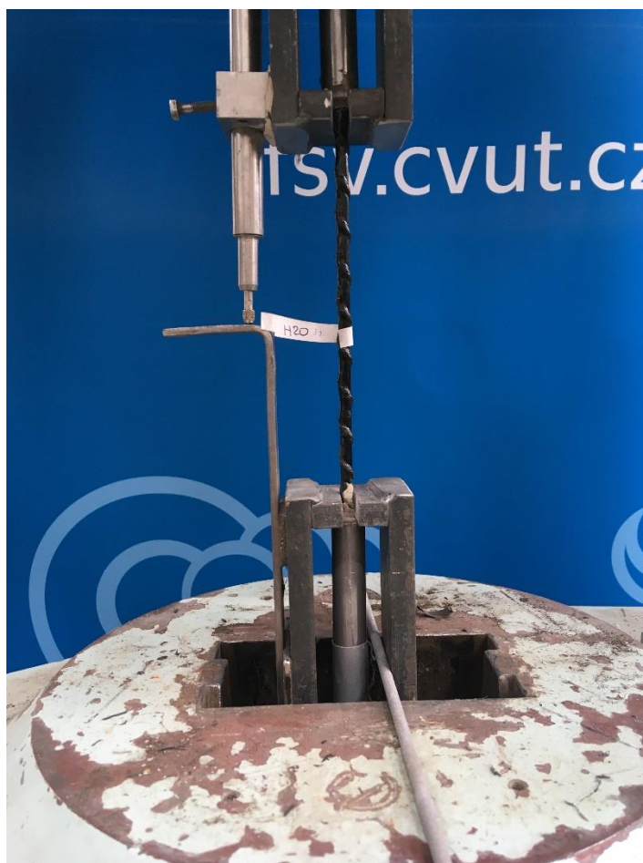
Obrázek 49: Uchycení vzorku v lisu s vsazeným ocelovým rámem
