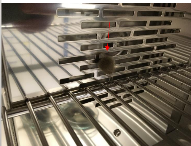
Obrázek 88 a 89: Přischlá vlákna v hrdle baňky a Nasátý shluk vláken v sušárně
