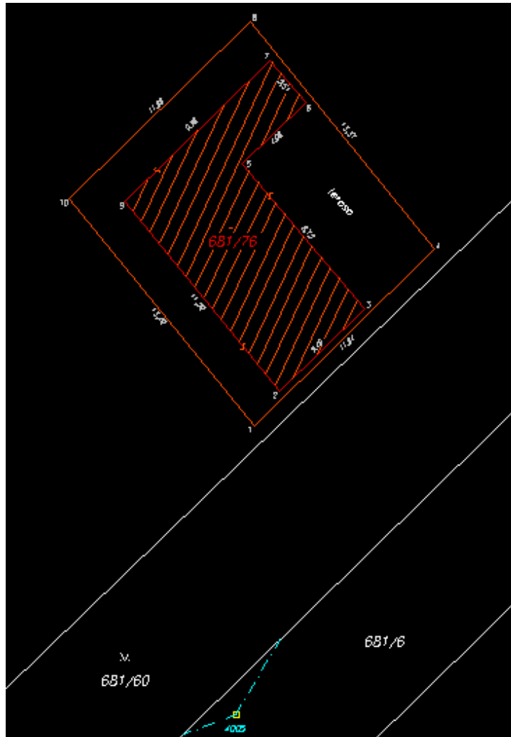
Obrázek 29: Ukázka měřického náčrtu pro GP vyznačení obvodu budovy v programu KOKES
