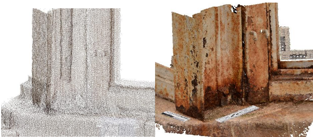
Obr. 54: Mračno bodů – laserové skenování (vlevo), fotogrammetrie (vpravo)
