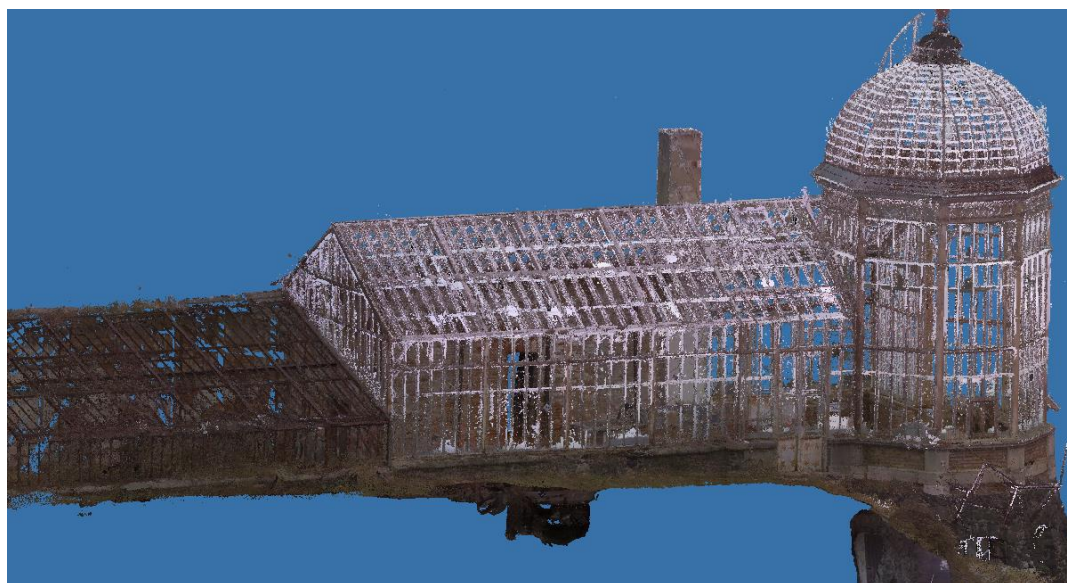
Obr. 26: Šum na zasklené části skleníku
