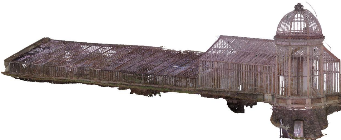
Obr. 33: Pohled na výsledné mračno
