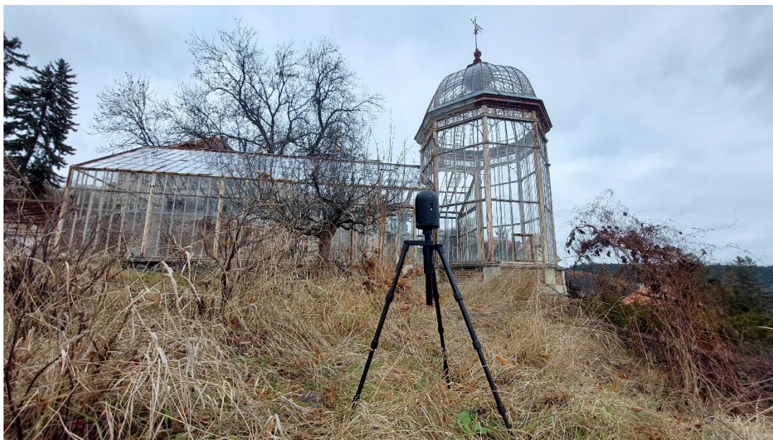
Obr. 9: Laserové skenování skenerem Leica BLK360 (Foto Adam Hrdina)
