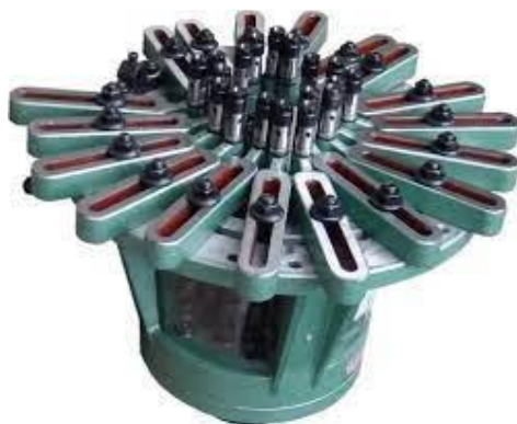
Obrázek 2 - Vícevřetenová vrtací hlava s flexibilní polohou vřeten, kloubový náhon [3]
