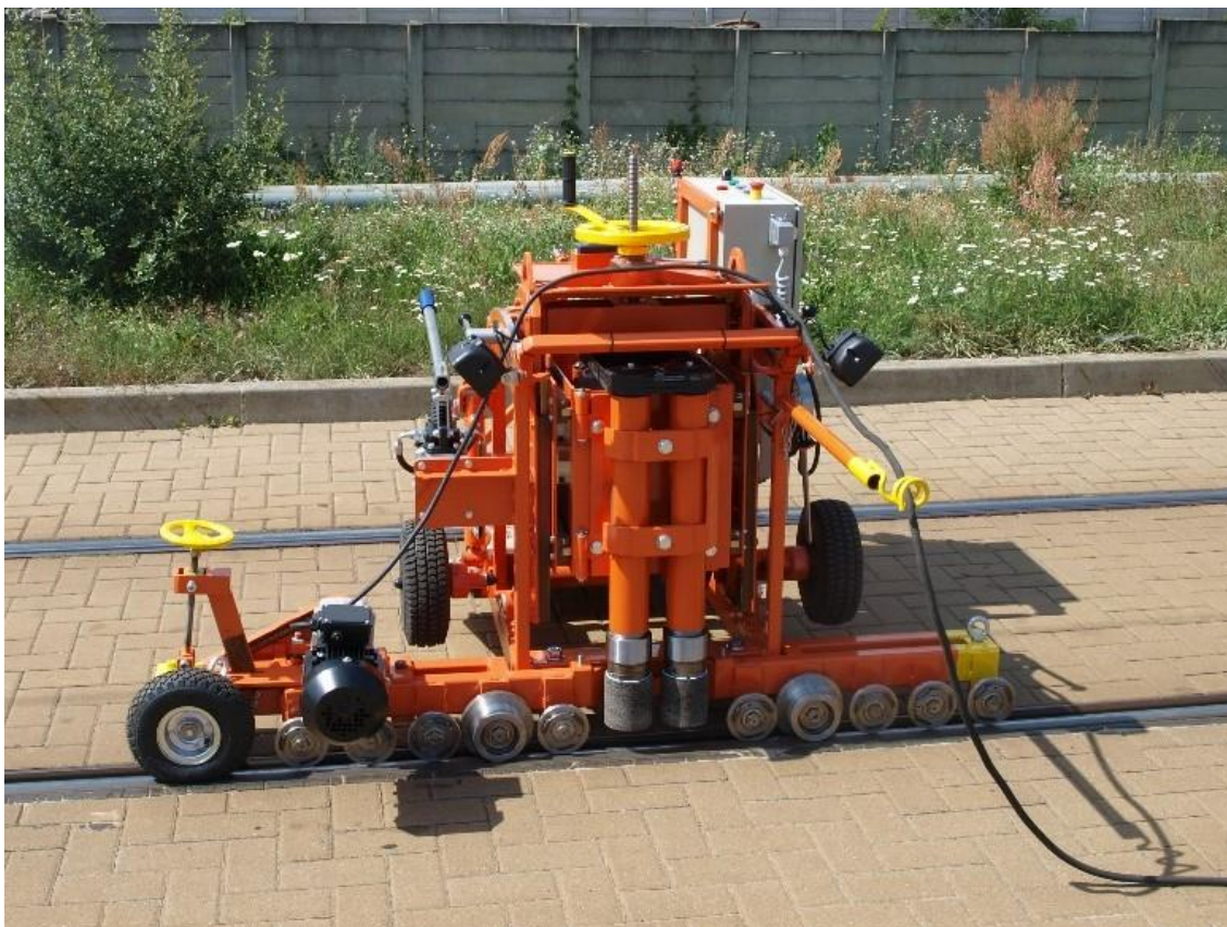
Obr. 17: Malý ruční brusný stroj BS2 [14]
