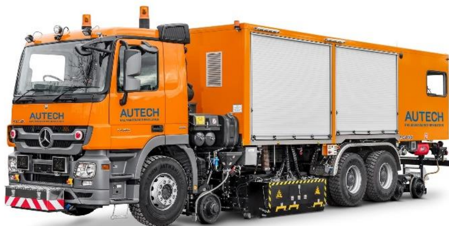
Obr. 19: Brusné vozidlo AT2200 [41]
