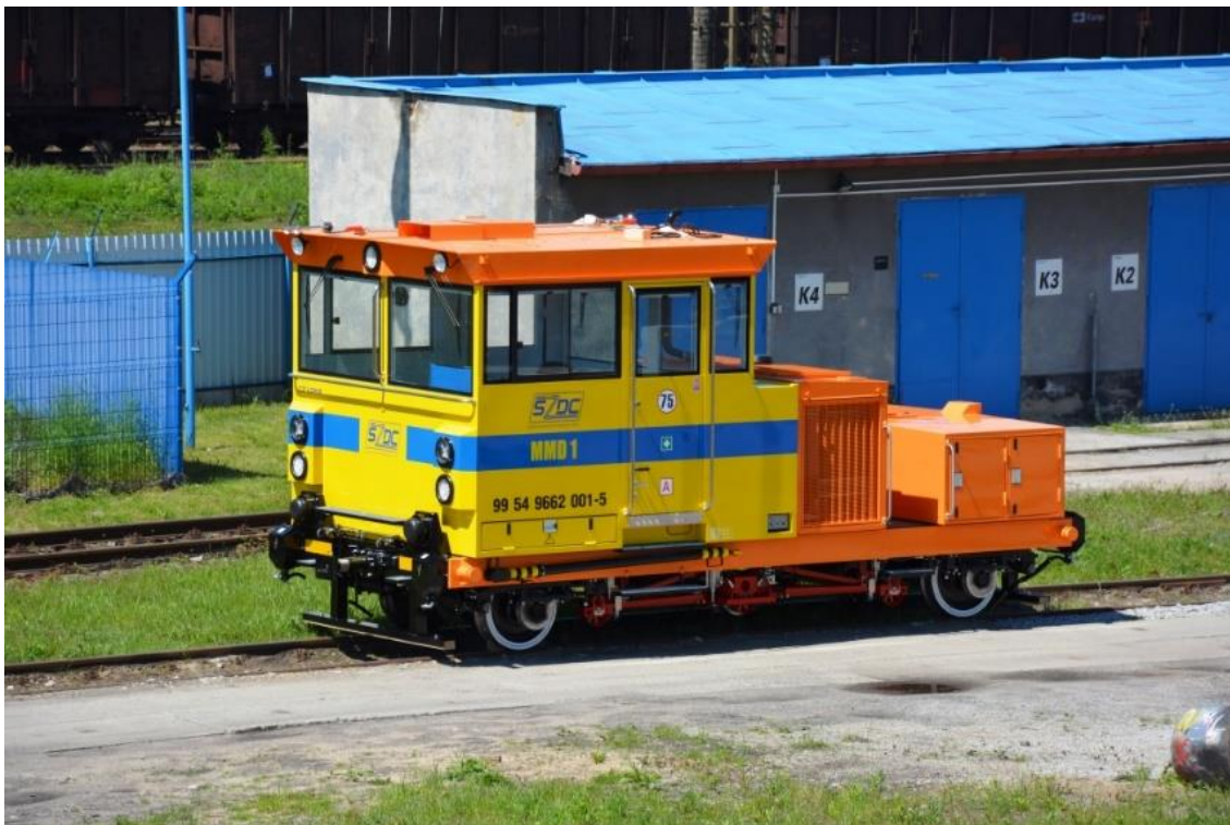
Obr. 15: Malá měřicí drezína [36]
