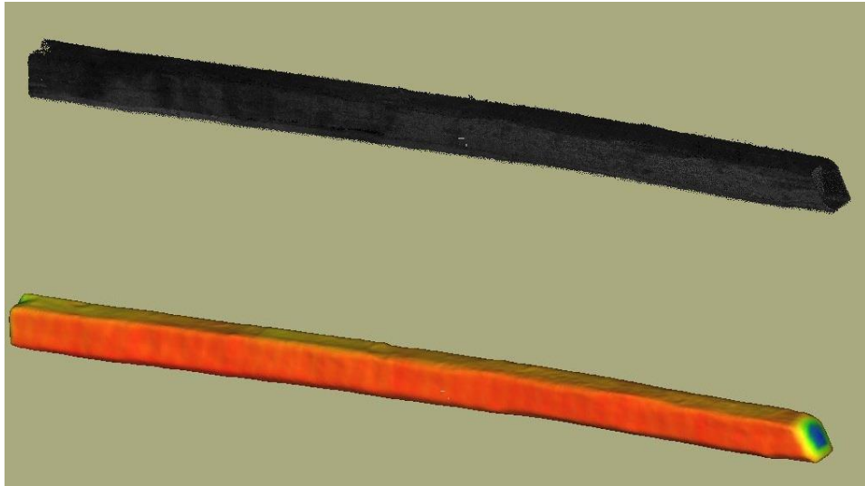
Obr. 65: Laserové skenování - mračno vs mesh – prvek 3
