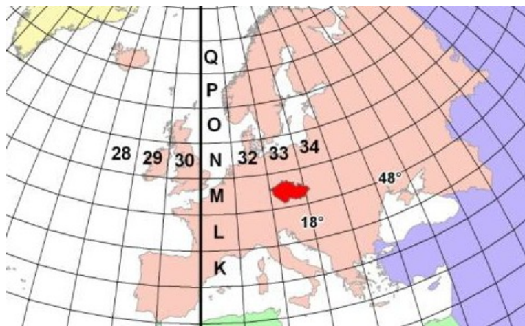
Obrázek 1 - Listy Mezinárodní mapy světa 1 : 1 000 000 s vyznačenou polohou ČR Zdroj: Talhofer Václav, plk. doc. Ing. CSc. a kolektiv: Vojenská topografie (Skripta) [6]
