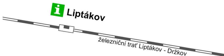
Obrázek 25 – Rotace symbolů: špatný výsledek transformace - rotace nesprávných symbolů
