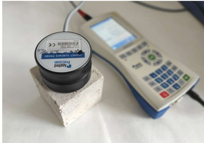
Obrázek 14: Měření tepelných vlastností pomocí ISOMET 2114
