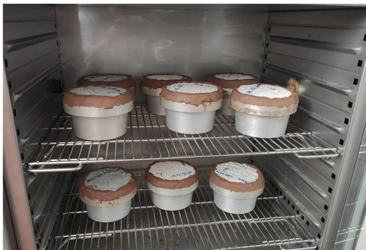
Obrázek 17: DRY-CUP metoda – vzorky v klimatické komoře
