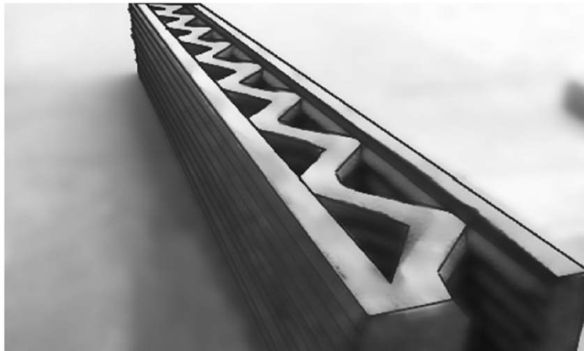
Obrázek 22 Příklad vylehčené stěnové struktury tvaru příhrady [23]
