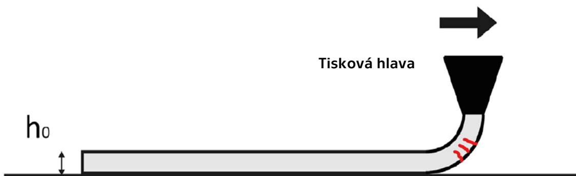
Obrázek 23 Naznačení tahových trhlin při spodní straně filamentu vzniklých při extruzi [23]
