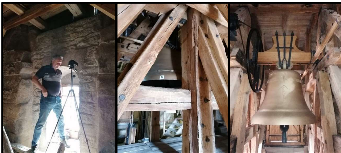
Obr. 22: Kamera sledující pohyb zvonu.
