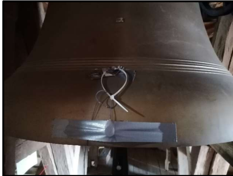
Obr. 28: Akcelerometr umístěn na zvonu.
