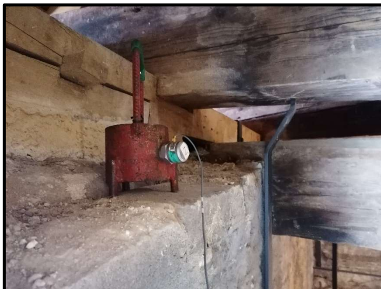
Obr. 11: Akcelerometr od firmy Brüel & Kjær typu 8344 připevněný k ocelovému závaží.
