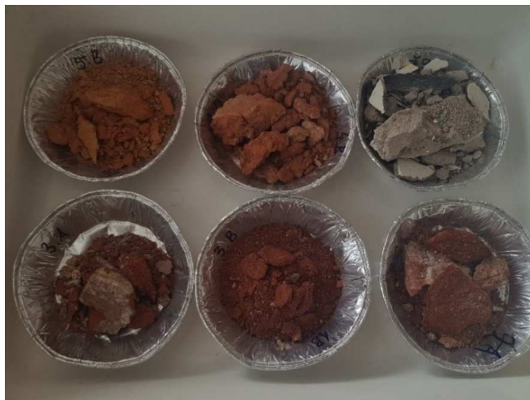
Obrázek 84: Nevysušený vzorek v označené hliníkové misce
