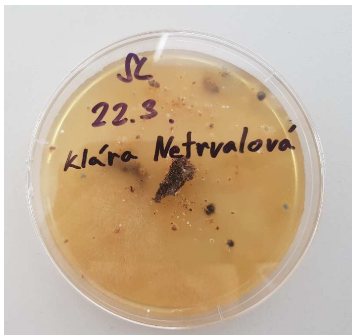
Obrázek 97: Vzorek v Petriho misce se sladovým roztokem po 15 dnech
