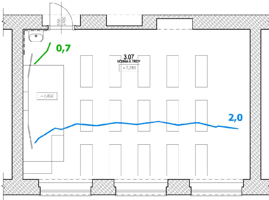
Obr. 97 – Kmenová učebna 6. třídy s vyznačenou izočarou pro hodnoty D_{TM} = 0,7 \% a D_T = 2,0 \% , dle současně platné normy ČSN EN 17037
