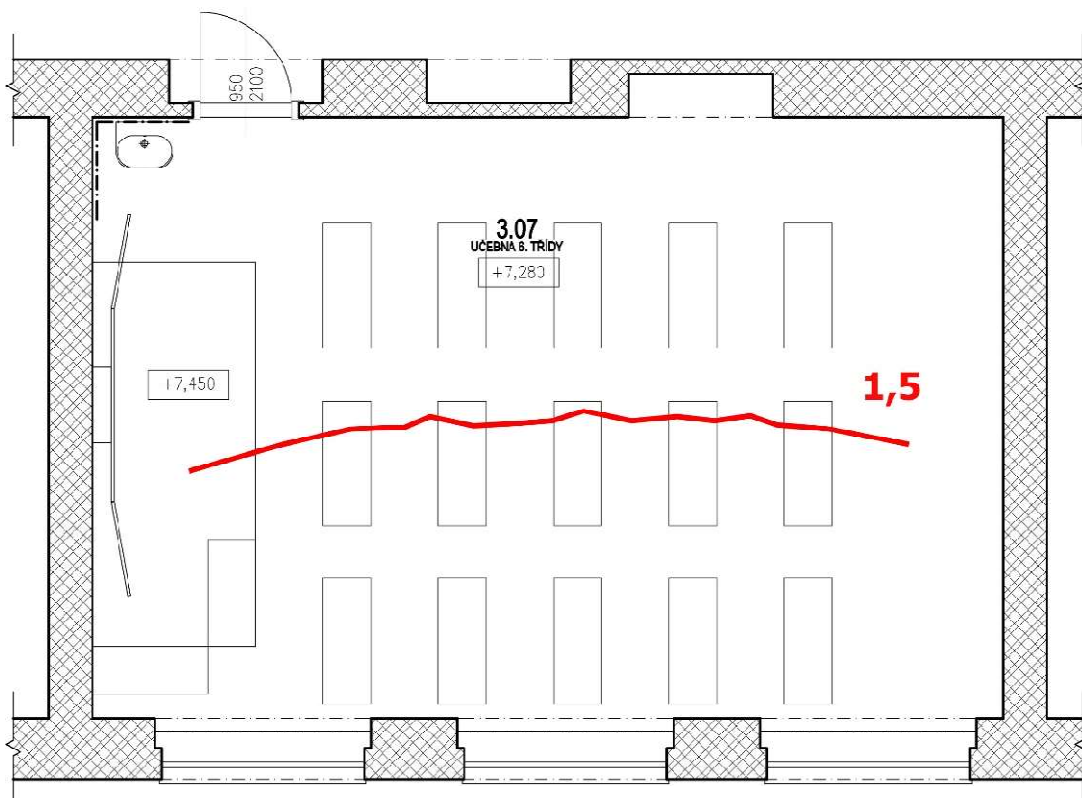
Obr. 96 – Kmenová učebna 6. třídy s vyznačenou izočarou pro hodnotu D = 1,5 \% , dle původně platné normy ČSN 73 0580-1
