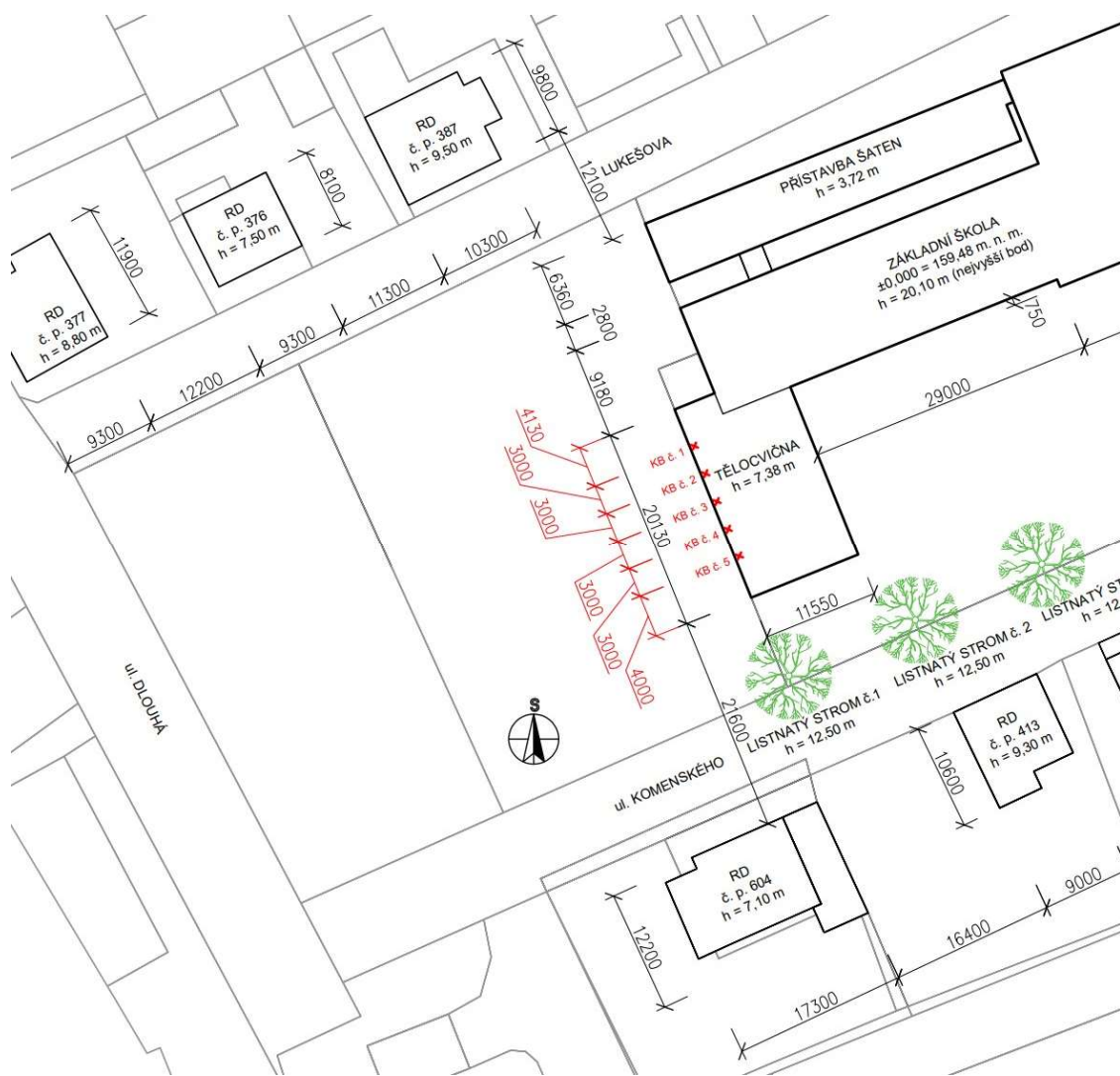
Obr. 125 – Výřez ze situace stínících objektů pro výpočet doby proslunění (viz. Výkres č. 6)
