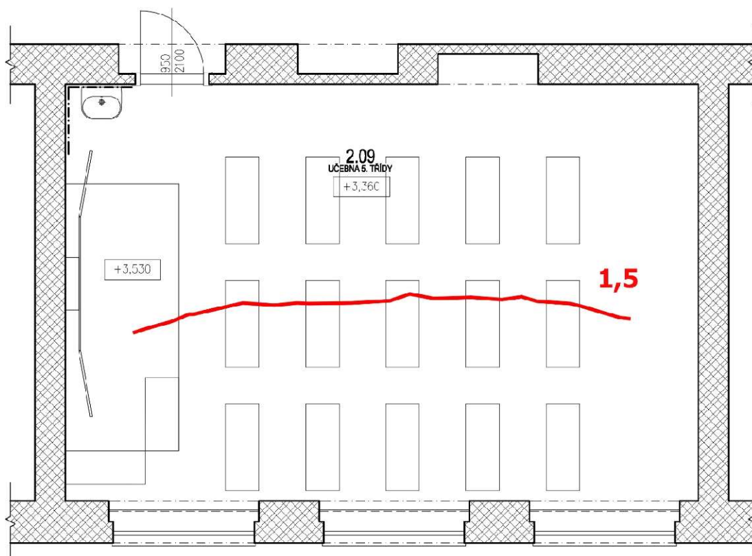
Obr. 73 – Kmenová učebna 5. třídy s vyznačenou izočarou pro hodnotu D = 1,5 %, dle původně platné normy ČSN 73 0580-1
