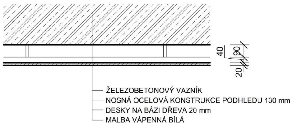
Obr. 41 – Řez skladbou stávajícího podhledu v tělocvičně
