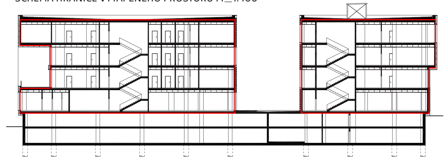
SCHÉMA HRANICE VYTÁPĚNÉHO PROSTORU M_1:400
