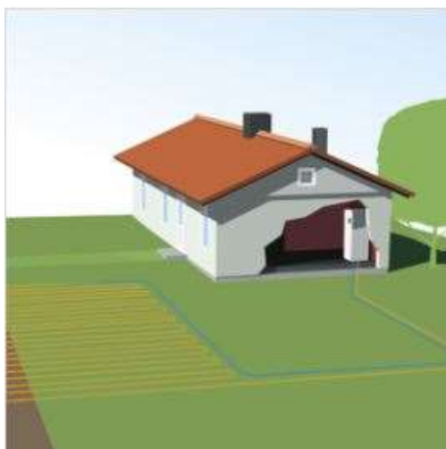
Obrázek 6 - Tepelné čerpadlo země – voda, plošná kolektor [12]
