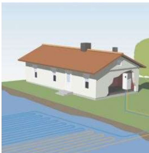
Obrázek 8 - Tepelné čerpadlo voda – voda, plošný kolektor [12]
