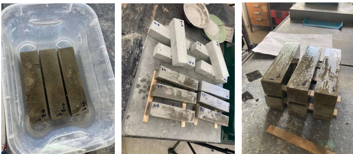
Obr. 21 - Impregnace zkušebních těles
