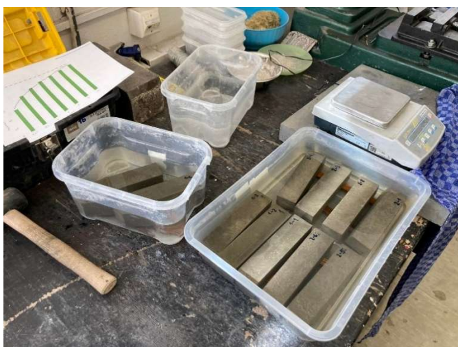
Obr. 22 - Zkušební tělesa namočená ve vodě
