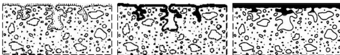
Obr. 3 - Hydrofobní impregnace, impregnace, nátěr (zleva) [7]
