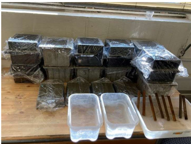
Obr. 17 - Zkušební tělesa ve formách
