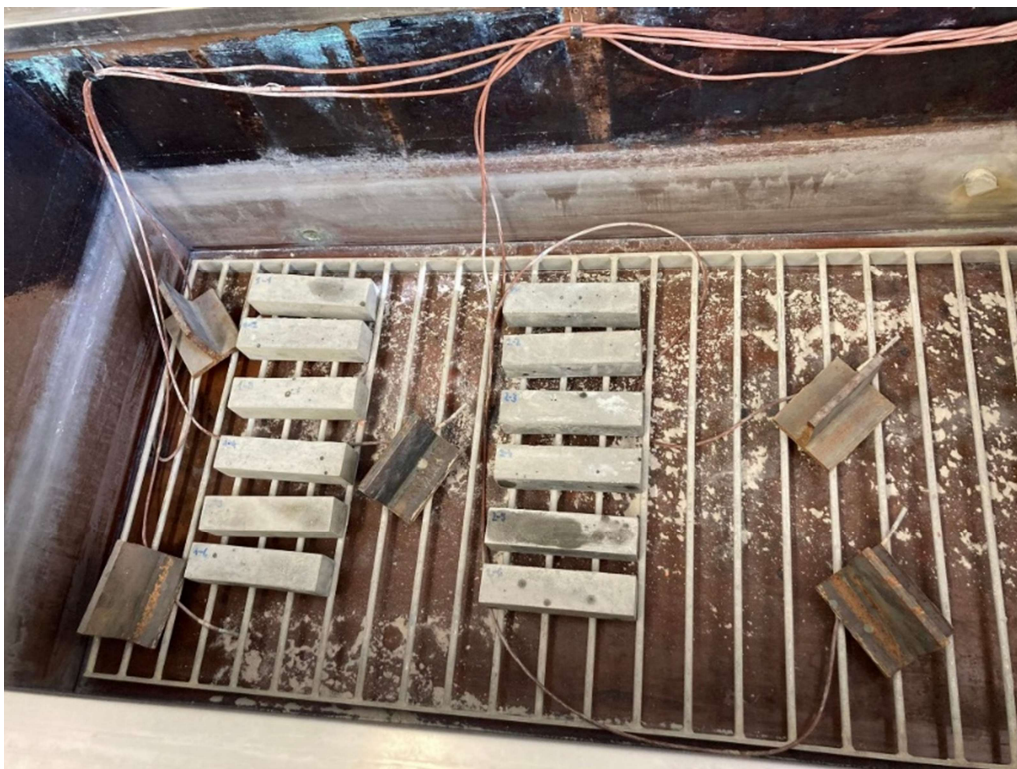
Obr. 24 - Zkušební tělesa umístěna do mrazícího boxu
