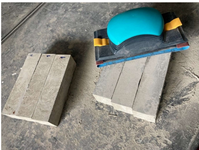
Obr. 20 - Broušení zkušebních těles
