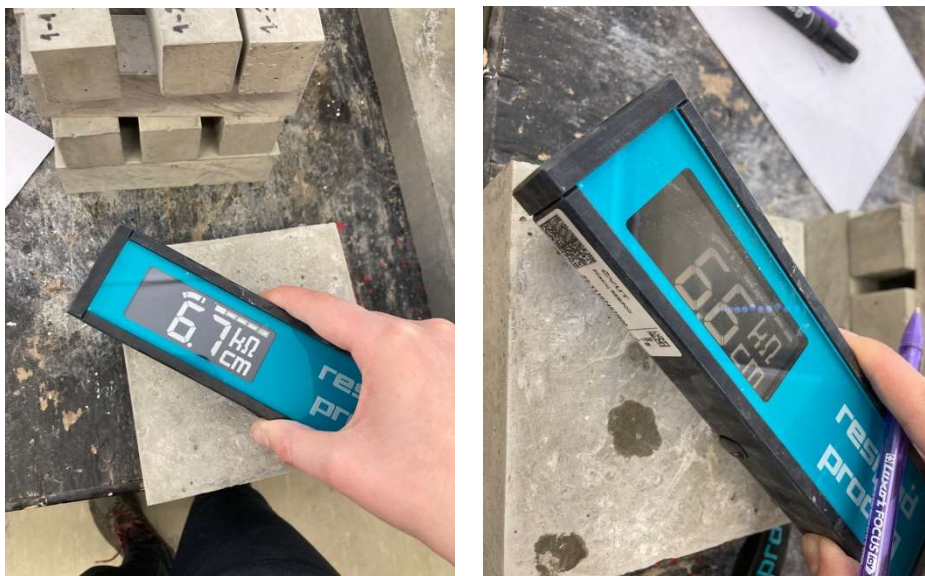
Obr. 32 - Měření s přístrojem Resipod
