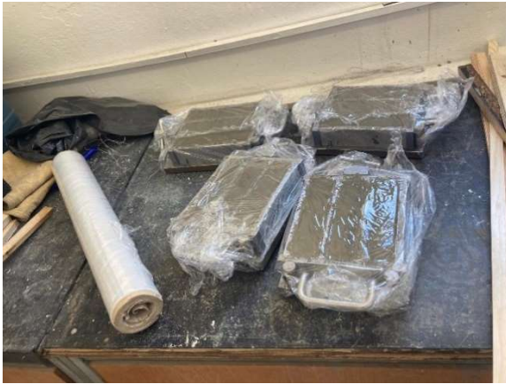
Obr. 19 - Zabalení forem do folie a umístění do pece
