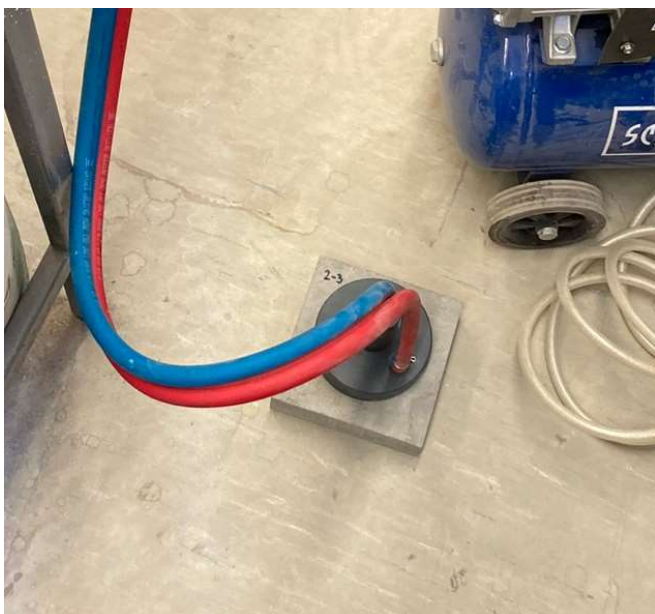
Obr. 34 - Měření s přístrojem Torrent
